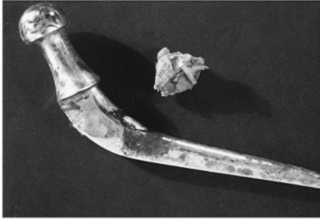
Resim 2.2. Paslanmaz çelikten yapılmış kalça implantında meydana gelen korozyon hasarı (İbrahim ve diğerleri, 2017)
