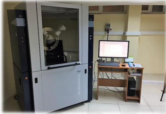
Resim 4.15. Gazi Üniversitesi Metalurji ve Malzeme Mühendisliği Bölümüne ait XRD Laboratuvarı, Bruker D8 Advance X-ışını kırınım cihazı
