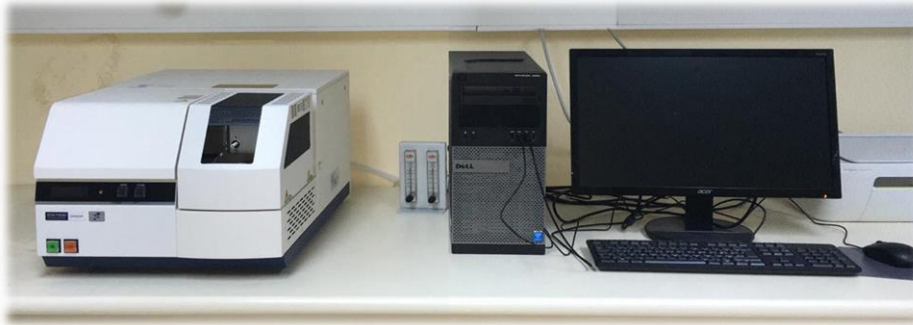
Resim 4.14. Gazi Üniversitesi Metalurji ve Malzeme Mühendisliği Bölümüne ait Termal Analiz Laboratuvarı, Hitachi STA7300 Termogravimetrik Analiz (TGA) ve Diferansiyel termal analiz (DTA) cihazı
