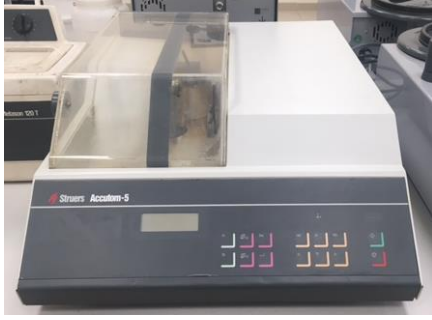
Resim 4.2. Struers Accutom-5 hassas kesme cihazı
