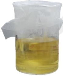
Resim 4.6. Karıştırma sonrası elde edilen kaplama solüsyonu
