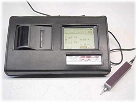
Resim 4.13. Manisa Celal Bayar Üniversitesi Makine Mühendisliği Bölümü Metalografi Laboratuvarı Mitutoyo SJ-301 yüzey pürüzlülüğü ölçüm cihazı
