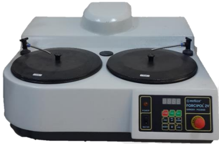
Resim 4.3. Metalografik numune zımparalama cihazı
