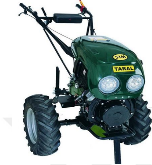
Şekil 1.4. Tek akslı iki tekerlekli traktör
