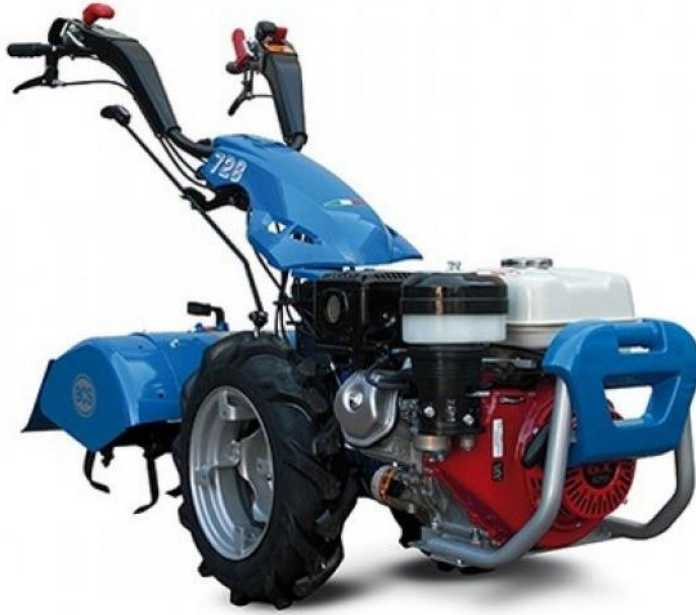
Şekil 1.8. Toprak frezeli tek akslı iki tekerlekli traktör
