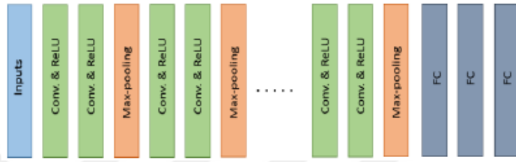
Şekil 3.23. VGGNet yapısı (Alom ve ark. 2018)
