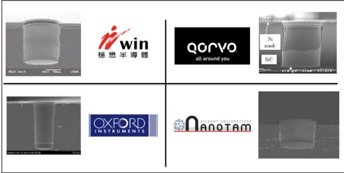
Resim 4.9. Farklı çalışma gruplarının elde etmiş olduğu SiC geçiş deliği profil karşılaştırması [33-35]
