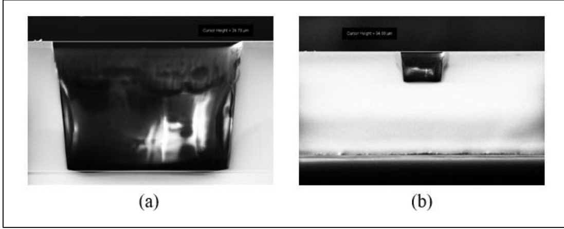
Resim 4.1. (a) CF_4 ve O_2 gaz karışımı ile elde edilen geçiş deliği profilinin SEM görüntüsü (b) SiC malzemesinin kesit alttaşı ile birlikte kesit görüntüsü
