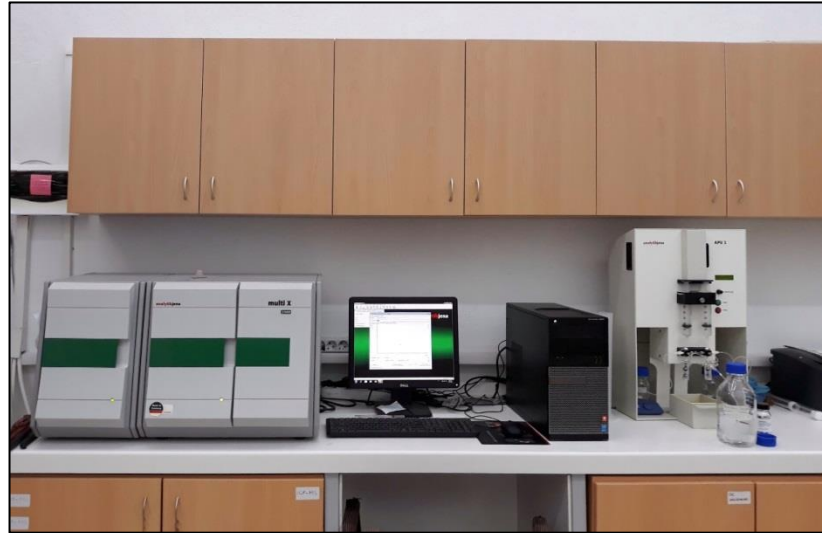
Şekil 3.4. Analytik Jena Multi X 2500 cihazı
