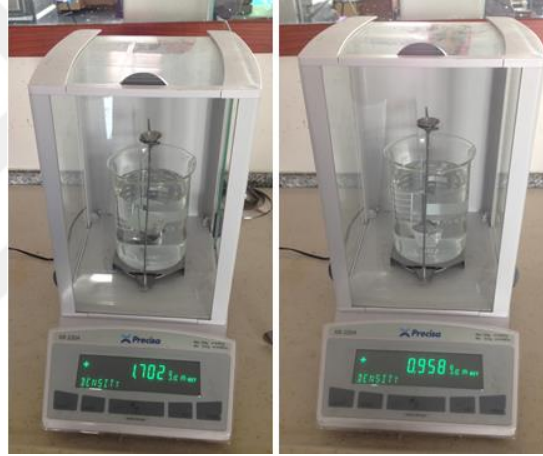
Şekil 3.20. Kompozit yoğunluğu testi.
