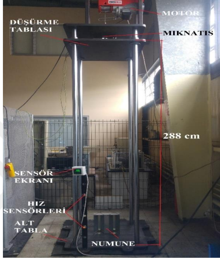
Şekil 3.1. Serbest düşme test düzeneği
