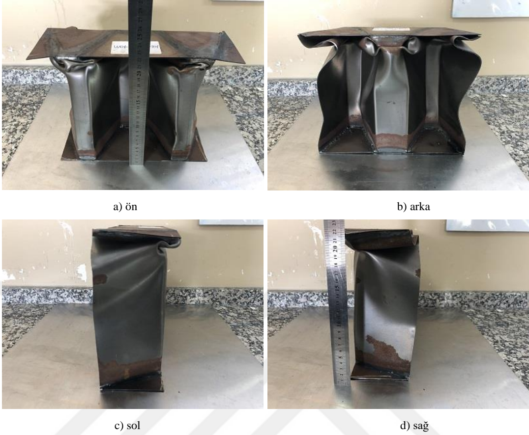
Şekil 4.33. W01-I1.2-S01-T01 kodlu numunenin çarpışma testi sonrası durumu
