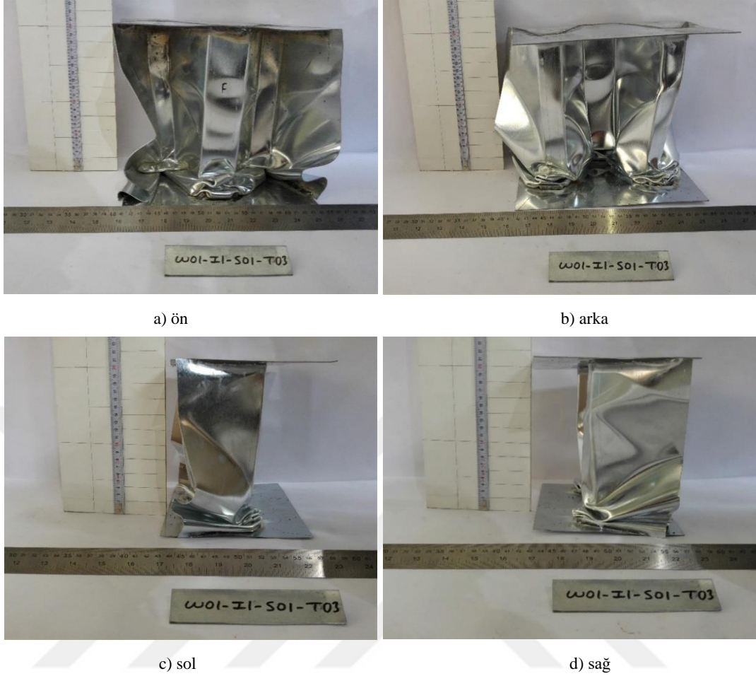
Şekil 4.11. W01-I1-S01-T03 nolu numunenin çarpışma sonunda ki ölçüleri
