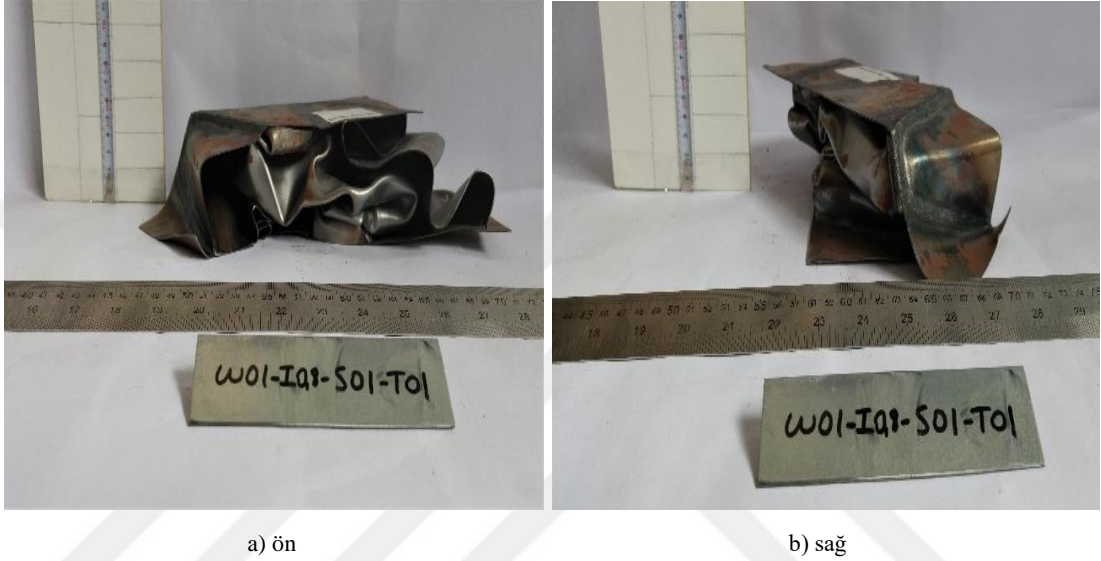
řekil 4.29. W01-I0,8-S01-T01 kodlu numunenin arpıřma sonrası durumu
