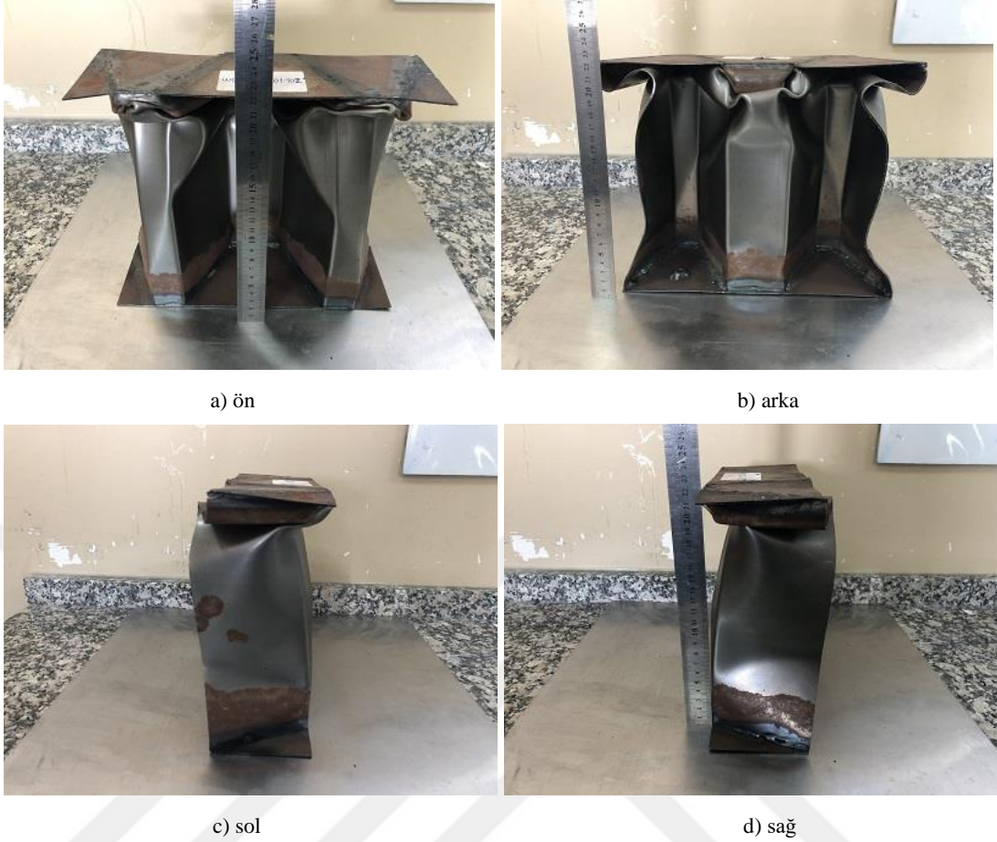
Şekil 4.34. W01-I1.2-S01-T02 kodlu numunenin çarpışma testi sonrası durumu
