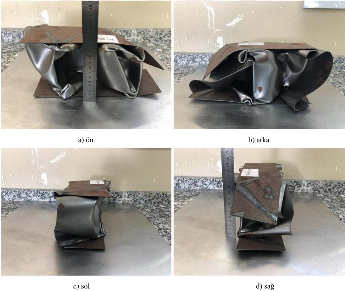
Şekil 4.25. W02-II-S01-T01 kodlu numunenin çarpışma testi sonrası durumu
