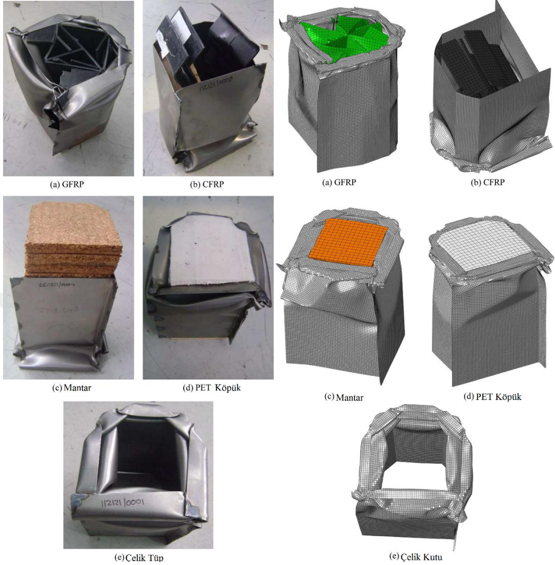
Şekil 1.20. Test sonrası numuneler ve numunelerin simülasyon sonuçları
