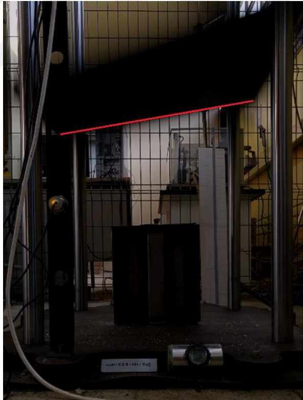
Şekil 4.32. Tablanın numuneye çarptığı açı
