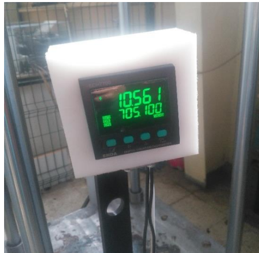
Şekil 4.10. Tablanın numuneye çarpma esnasında ki yaklaşık hızı
