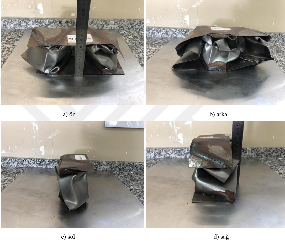
Şekil 4.22. W01-II-S02-T01 kodlu numunenin çarpışma testi sonrası durumu
