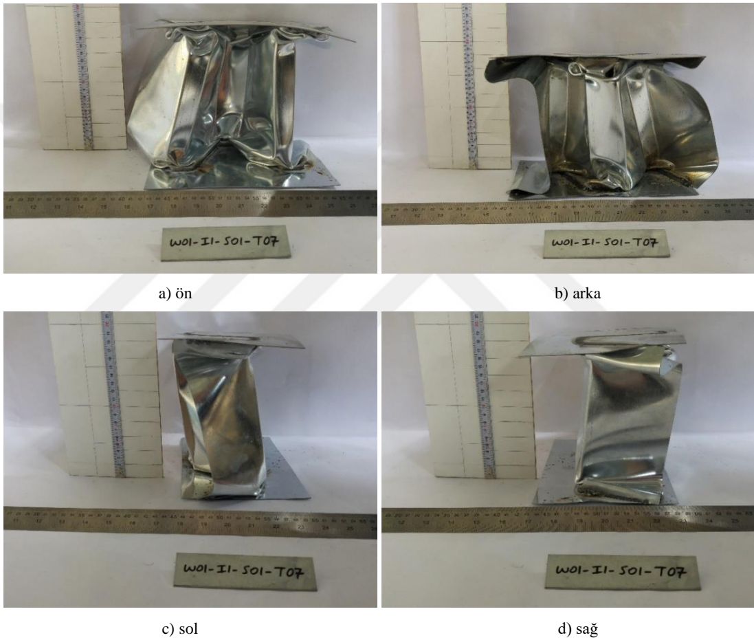
Şekil 4.19. W01-II-S01-T07 kodlu numunenin çarpışma testi sonrası durumu
