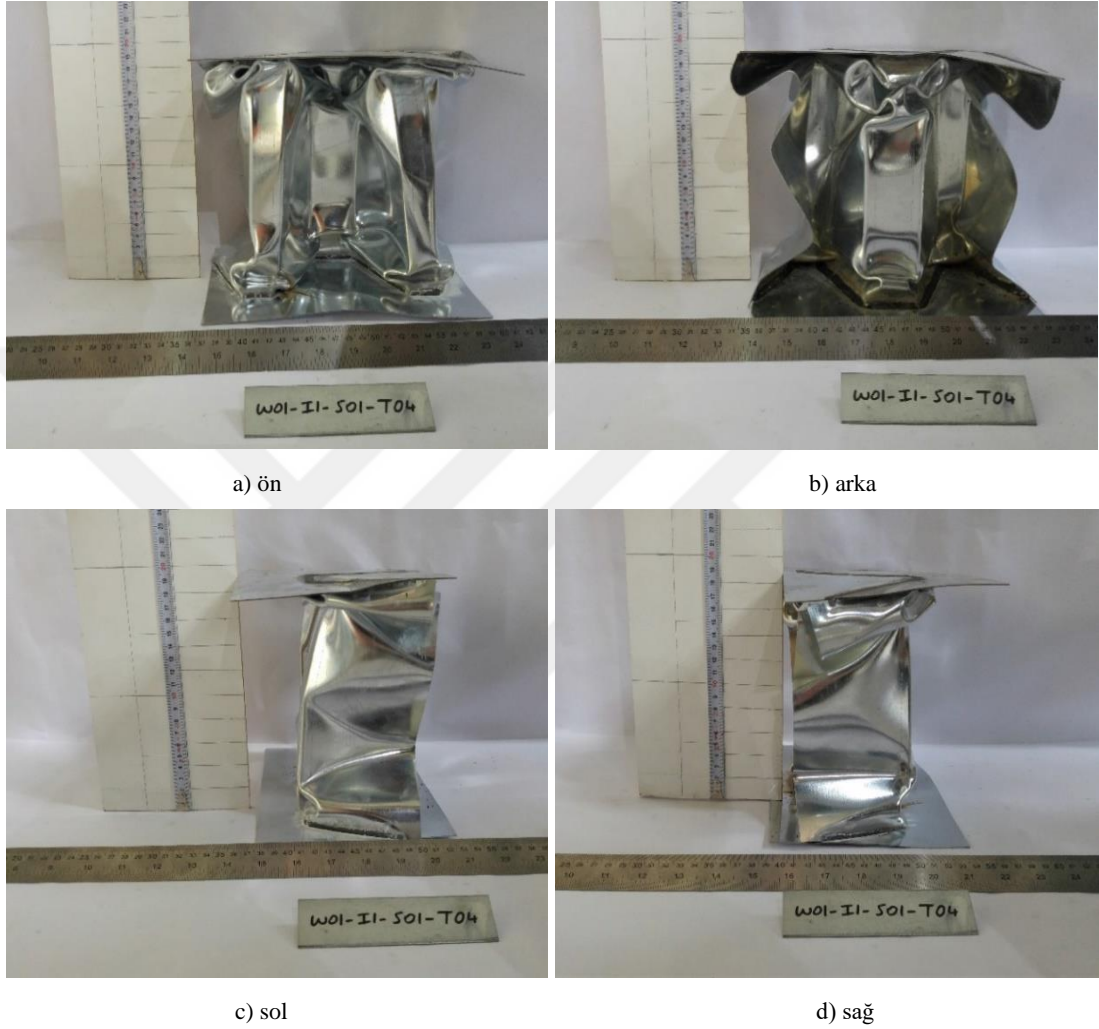
Şekil 4.12. W01-II-S01-T04 kodlu numunenin çarpışma sonrası ölçüleri
