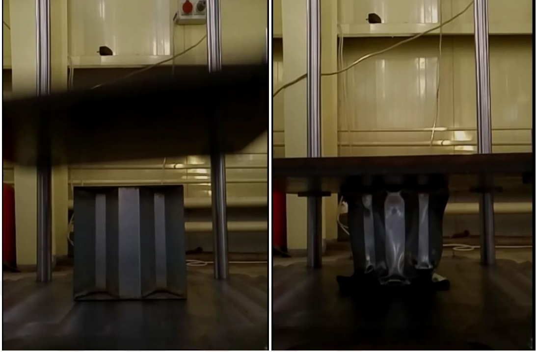
Şekil 4.5. Tablanın numuneye açıyla çarptığı an ve temas anı
