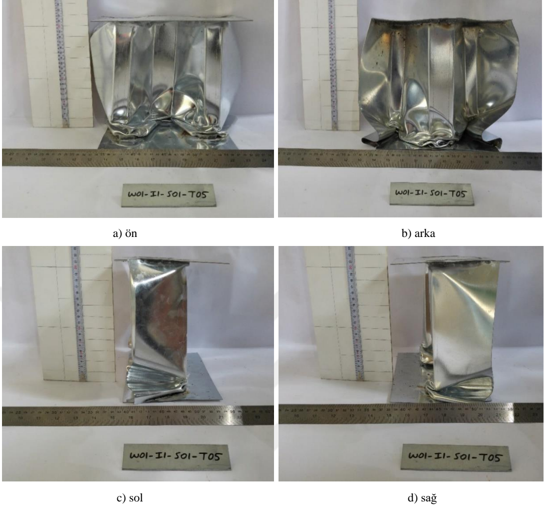
Şekil 4.14. W01-II-S01-T05 kodlu numunenin çarpışma testi sonunda ki durumu
