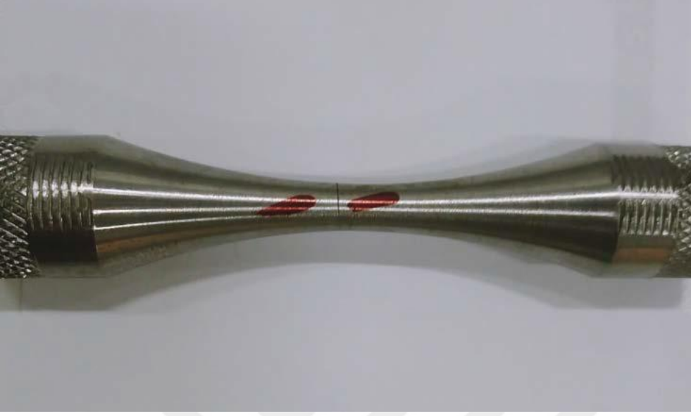
Şekil 5.17 Yorulma testinde hasar gören S460N malzeme numune görüntüsü
