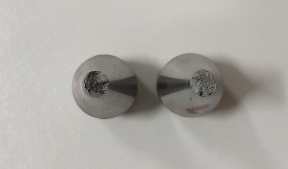
Şekil 5.18 Yorulma testinde hasar gören S460N malzeme numune kesit görüntüsü
