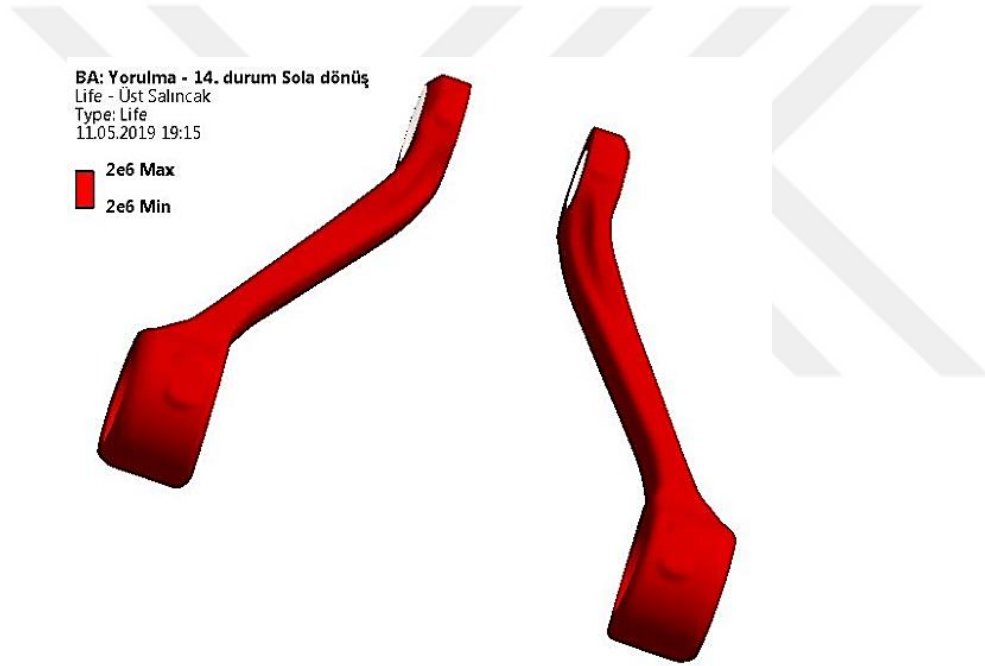
Şekil 5.25 Sola dönüş (0,75 G) yükleme koşulunda üst salıncak kollarının yorulma ömrü
