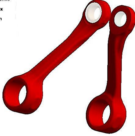
Şekil 5.21 Engelden geçme (tümsek 2,25 G) yükleme koşulunda üst salıncak kollarının yorulma ömrü
