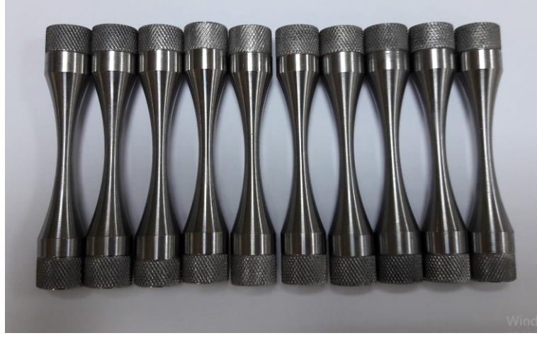
Şekil 5.7 ASTM E466-7 standardına göre hazırlanmış yorulma deney numuneleri.
