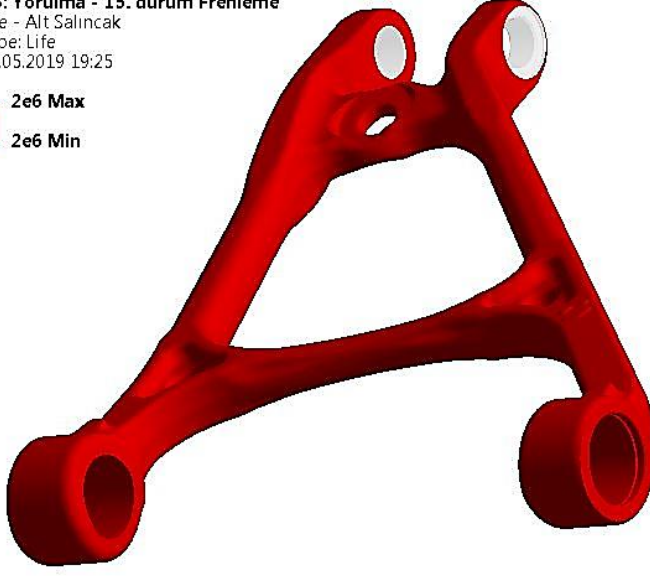
Şekil 5.31 Frenleme (0,75 G) yüklemde koşulunda alt salıncak kolunun yorulma ömrü
