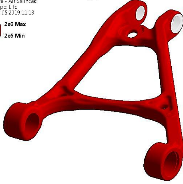
Şekil 5.23 Engelden geçme (tümsek 2,25 G) yükleme koşulunda alt salıncak kolunun yorulma ömrü
