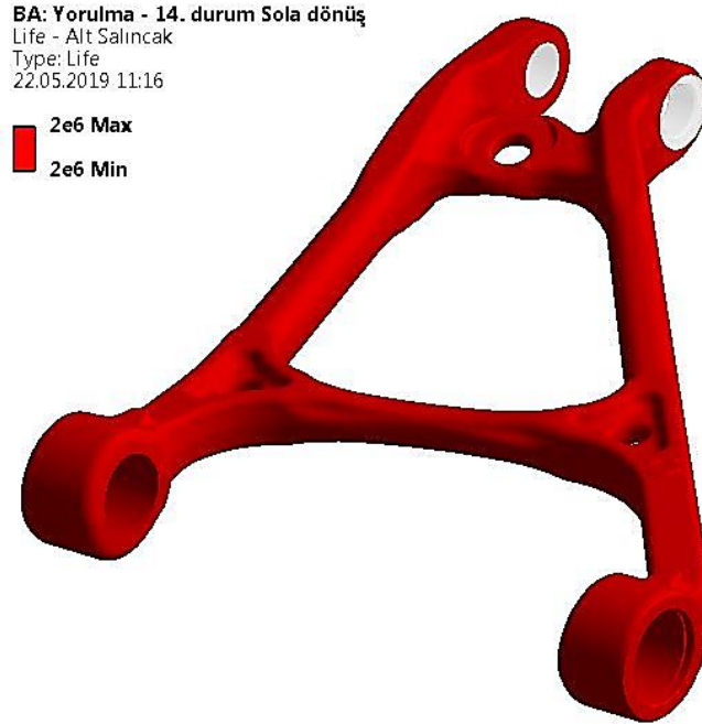
Şekil 5.27 Sola dönüş (0,75 G) yükleme koşulunda alt salıncak kolunun yorulma ömrü
