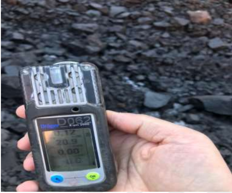
Şekil 4.7. Drager X-am 2500 Gaz ölçüm cihazı
