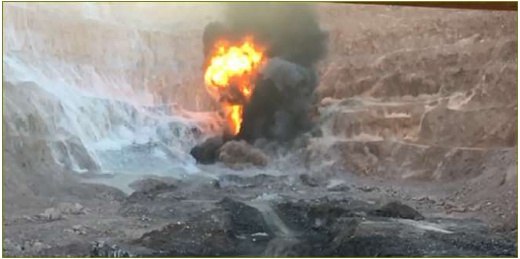
Şekil 3.16. Çıplak alevin gelişmesi -1
