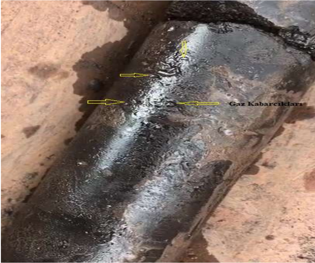
Şekil 4.2. Rezerv geliştirme sondajından alınan asfaltit karot yüzeyinde oluşan gaz kabarcıkları
