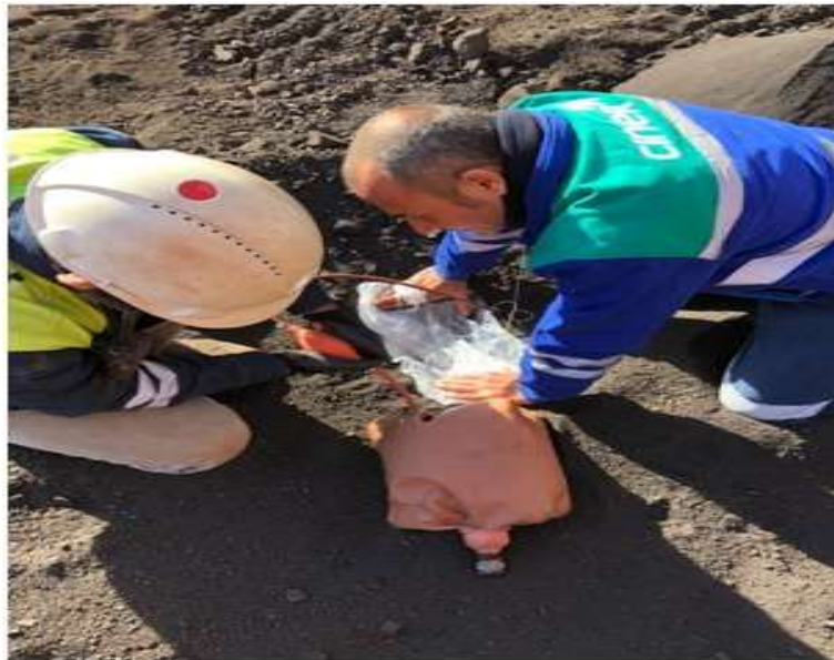
Şekil 4.6. Delik ağzında emici hortum ve pompa yardımıyla gaz ölçümü
