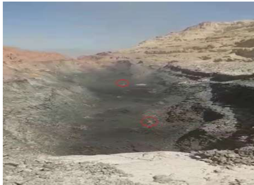
Şekil 3.20. Patlatma sonrası yangın başlangıcı
