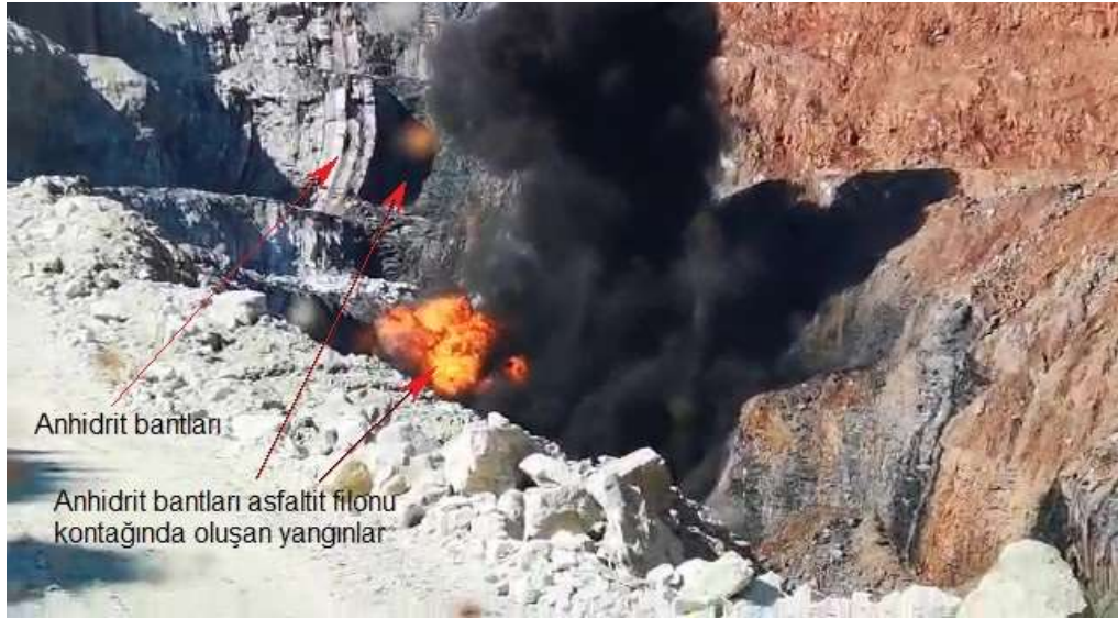
Şekil 3.24. Çıplak alevin gelişmesi -1
