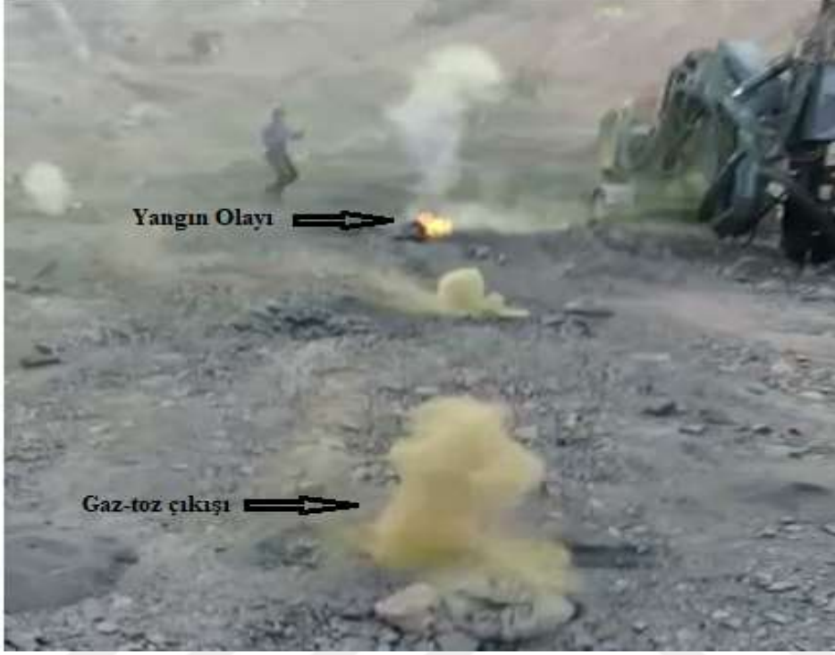
Şekil 4.5. Asfaltit patlatma deliklerinde medya gelen gaz çıkışı ve yangın oluşumu
