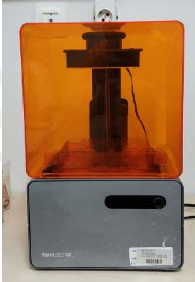
Şekil 2.3. Deneysel numunelerin üretildiği SLA cihazı
