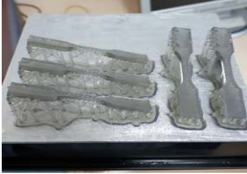
Şekil 2.4.% 0.50 Ag-% 0.50 Cu içeren 3B basılan çekme numuneleri
