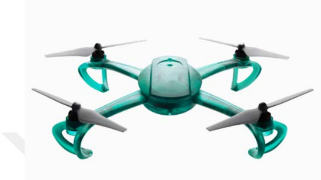
Şekil 1.2. SLA yöntemi ile üretilen drone prototipi
