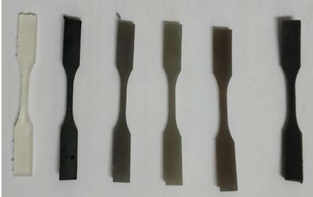
Şekil 2.5. Basımı tamamlanan çekme numuneleri soldan sağa doğru sırasıyla; saf, % 0.25 Ag-% 0.75 Cu, % 0.50 Ag-% 0.50 Cu, % 0.75 Ag-% 0.25 Cu, % 1 Ag ve % 1 Cu
