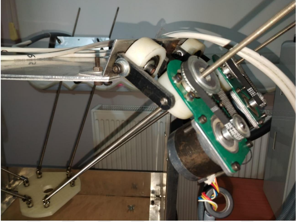
Şekil 4.5. Özgün tasarım olan actüatörlerin ara montajlı görünüşü.
