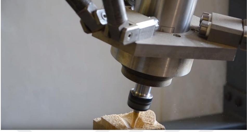
Şekil 2.5. PC tabanlı kontrolcü ile kontrol edilen hexapod robotun ahşap işleme anına ait görseli (pkmnc, 2012).
