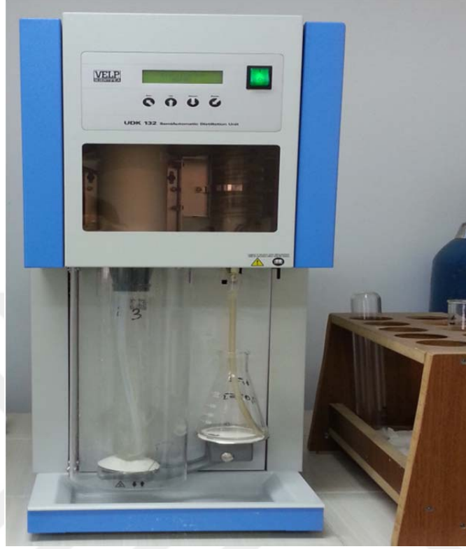
Şekil 3.2. Kjeldahl Metodu Azot Tayini Cihazı (Nötralizasyon ve Destilasyon Aşaması)
