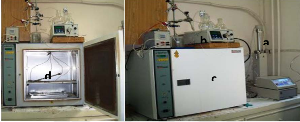
Şekil 3.1. Sub ve süperkritik akışkan ekstraksiyon sistemi (a: ISCO pompa; b: HPLC pompası; c: Fırın; d: Ekstraksiyon hücresi)
