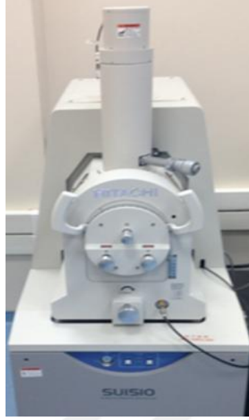
Resim 3.11 Hitachi SU 1510 EDS analiz cihazı (İnt.Kyn.10).
