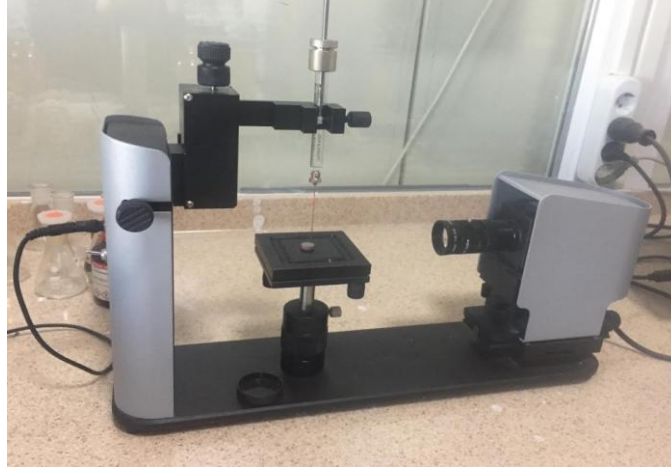
Resim 3.12 KSV Attension ThetaLite TL 101 Optical Tensiometre temas açısı analiz cihazı.
