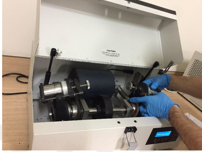
Resim 3.6 Spex™ 8000D ğütme cihazı.
