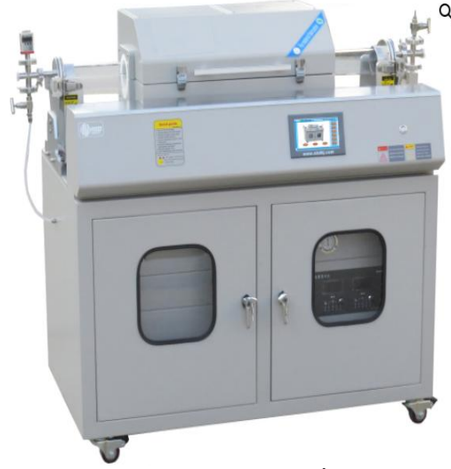
Resim 3.9 Laboratuvarda kullanılan sinterleme fırını (İnt.Kyn.9).
