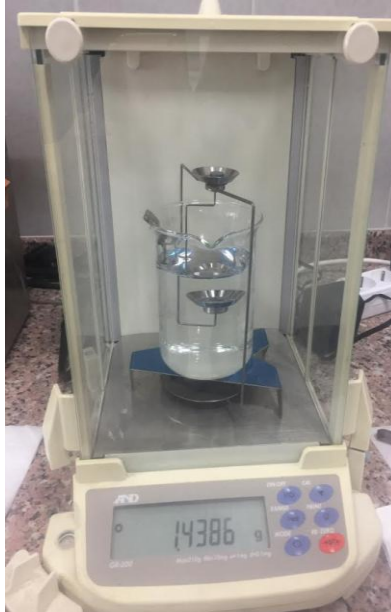
Resim 3.13 A&D GR 200 yoğunluk ölçüm cihazı.
