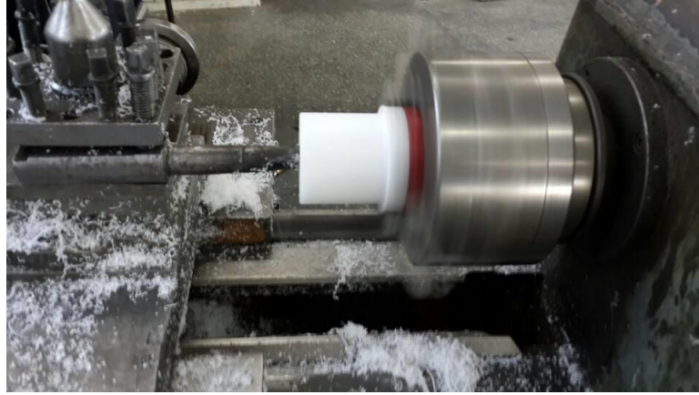
Şekil 3.8. PVC (Polivinilklorür) tekerleklerin tornada işlenmesi.
