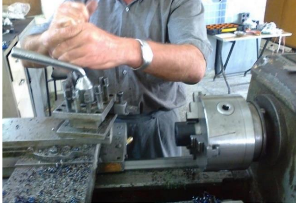
Şekil 3.9. Metal tekerlerin torna ile işlenmesi
