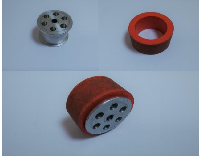
Şekil 3.11. Alüminyum tekerin silikon kaplanması
