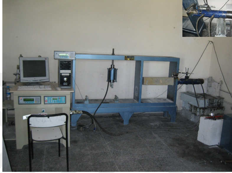
Şekil 3.3. Aderans deney çerçevesi ve aderans deneyinin yapılışı
