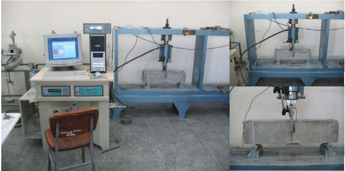
Şekil 3.5. Eğilme deneyinin yapılışı
