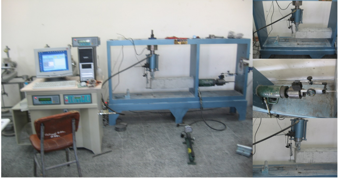
Şekil 3.6. Aderanslı eğilme deneyinin yapılışı
