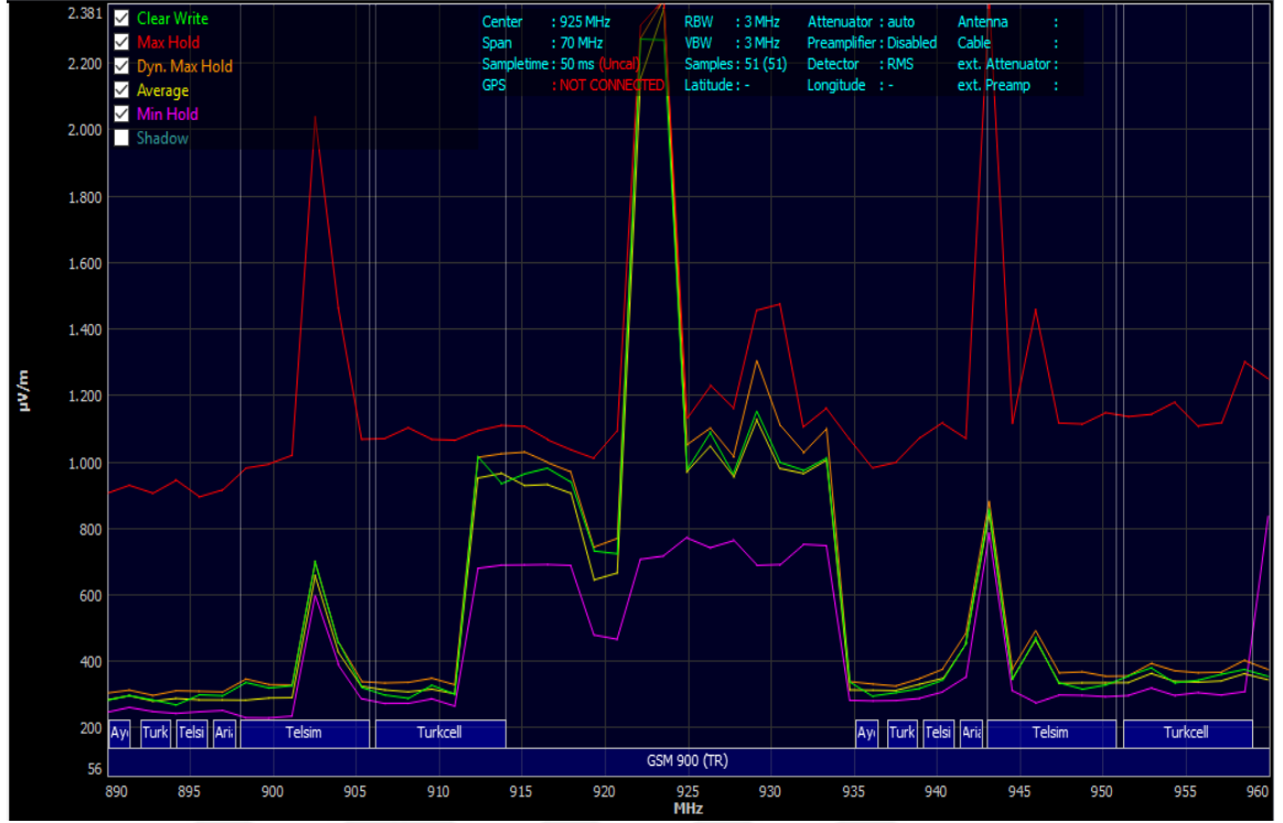
Şekil 3.4. Aaronia Spectran HF-60105 V4 Taşınabilir Spektrum Analizörü ile GSM 900 MHz frekansında alınan örnek elektrik alan spektrumu.
