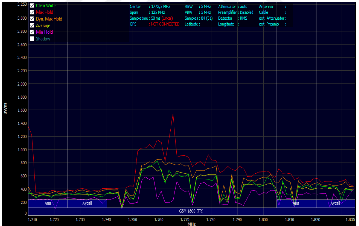
Şekil 3.7. Aaronia Spectran HF-60105 V4 Taşınabilir Spektrum Analizörü ile GSM 1800 MHz frekansında alınan örnek elektrik alan spektrumu.
