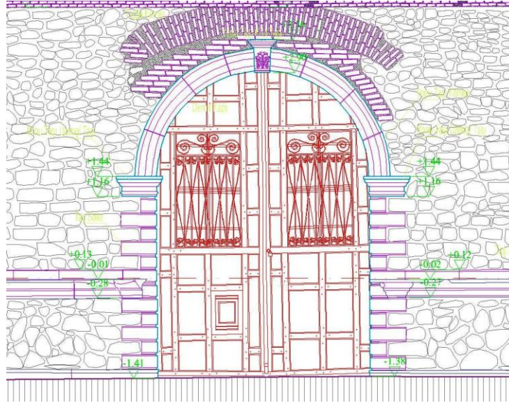
Şekil 3.36. Kuzey Cephe Giriş Kapı Açıklığı ve Kilit Taşı
