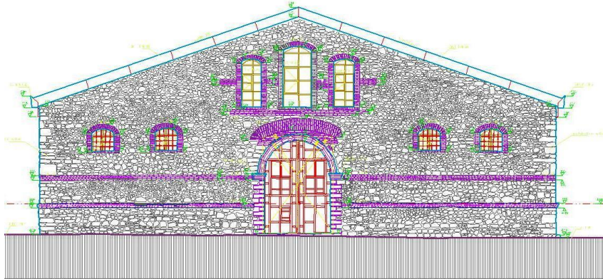
Şekil 3.31. Güney Cephe Görünüş Çizimi
