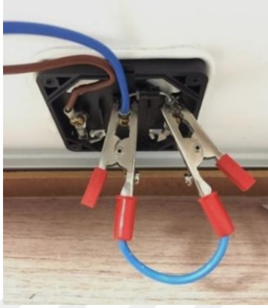
Şekil 6.23. Bir paneldeki kısa devre senaryosu.
