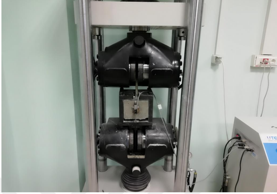
Şekil 3.14. Sıyırılma deneyi düzeneği
