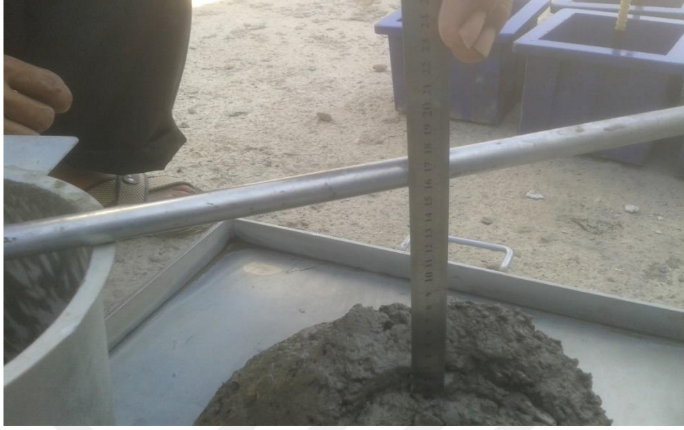
Şekil 3.5. Taze beton çökme deneyi
