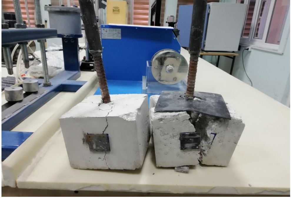
Şekil 4.13. Yüksek sıcaklık etkisine maruz kalan numunelerdeki CETP donatılarının renk değişimi
