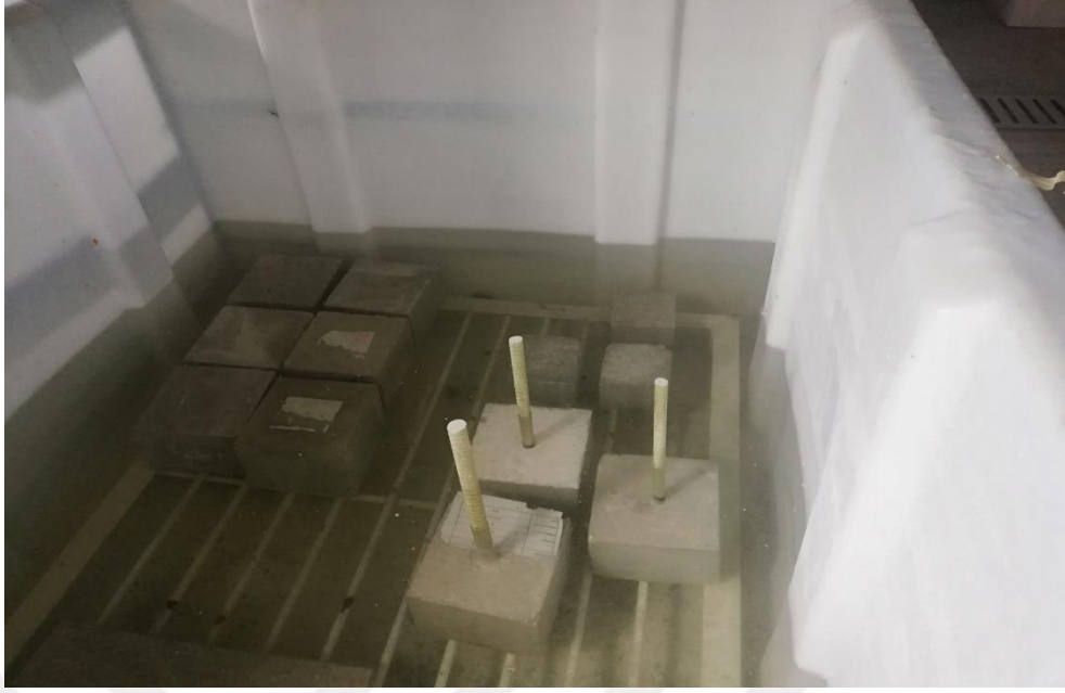
Şekil 3.9. Numunelerin kür havuzunda kür edilmesi
