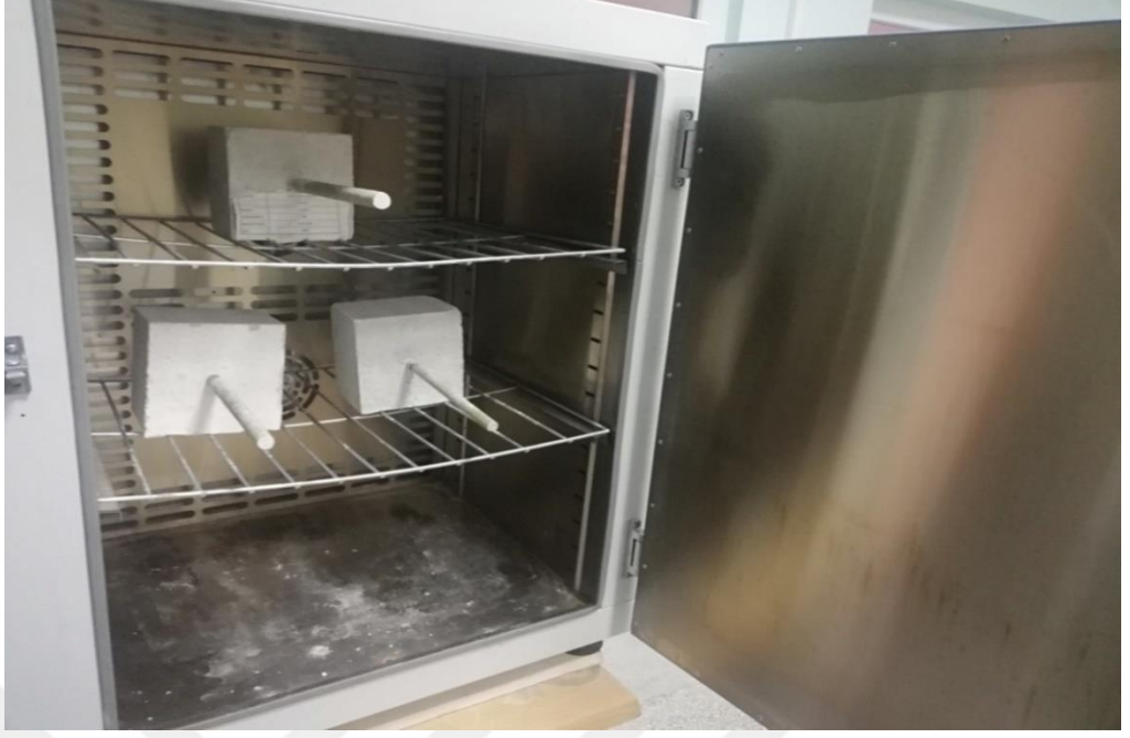
Şekil 3.10. Etüvde numunelerin yüksek sıcaklığa maruz bırakılması
