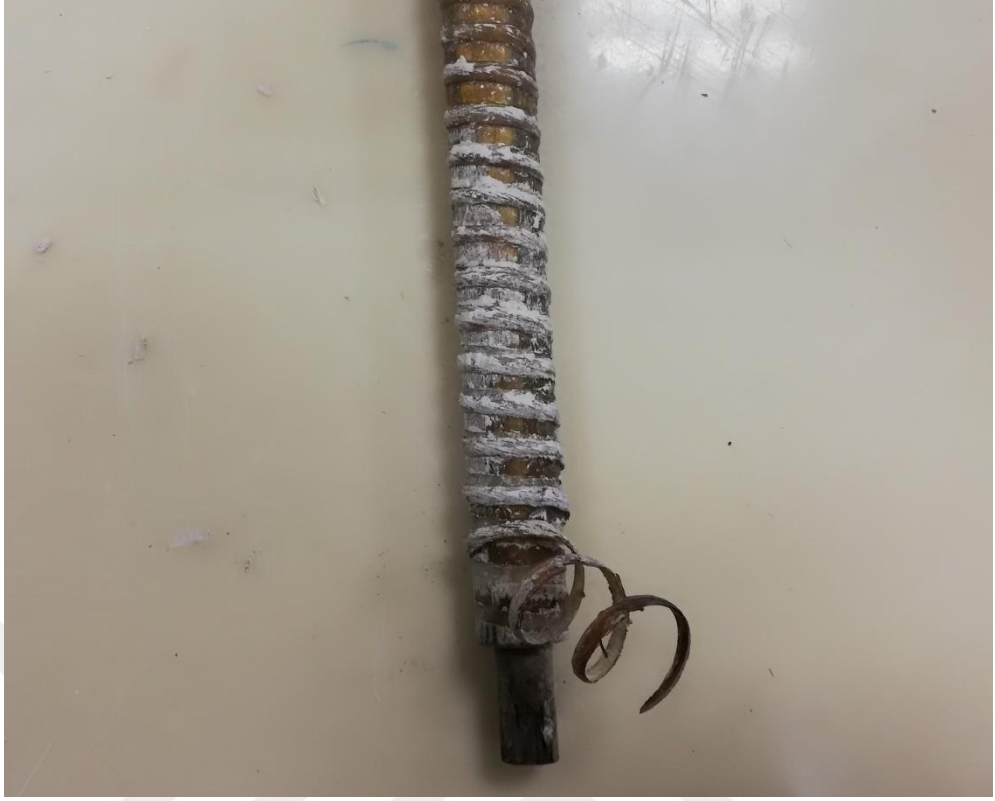
Şekil 4.14. Yüksek sıcaklık etkisine maruz kalan numunelerdeki CETP donatılarının nervür deformasyonu
