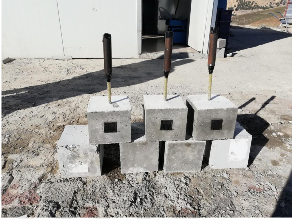
Şekil 3.12. Numunelere (40x40x4 mm) çelik plaka ve çelik başlığın montaj edilmesi
