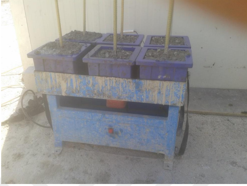
Şekil 3.8. Numunelerin sarsma tablasında vibrasyona tabi tutulması
