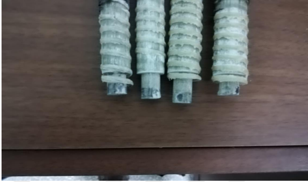
Şekil 4.4. C40 beton sınıfındaki numunelerde CETP donatılardaki nervürlerin aşınması
