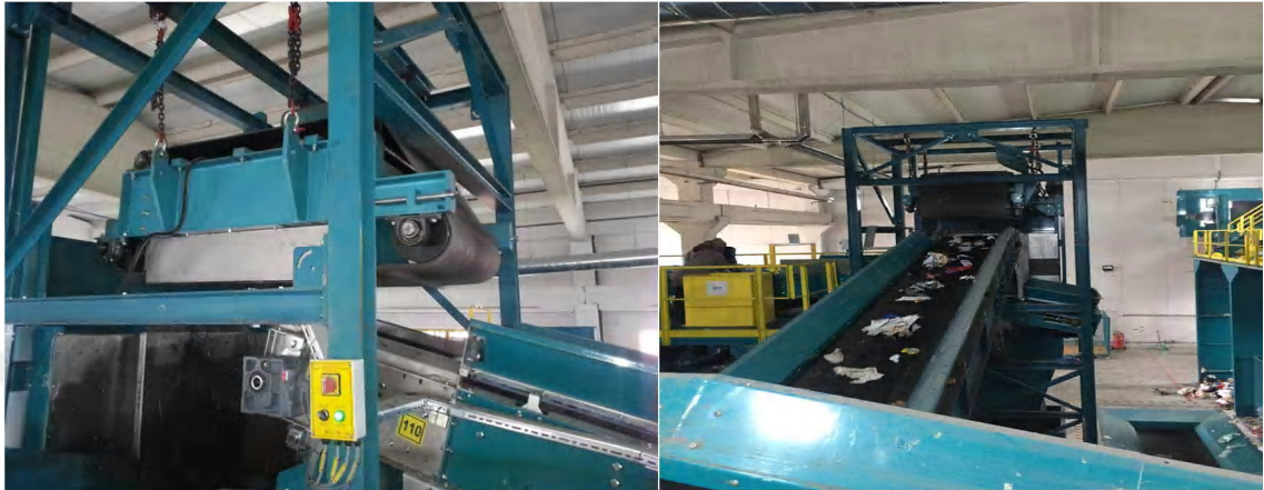
Şekil 1.20 Manyetik Konveyör Bölümü
