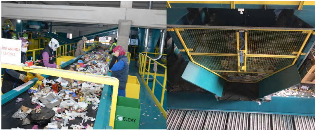
Şekil 1.18. İki Boyutlu Ayıklama Konveyör Bölümü
