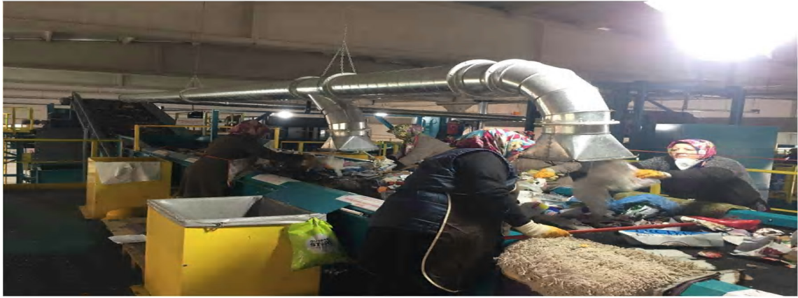
Şekil 1.15. Ön Ayıklama Konveyör Bölümü
