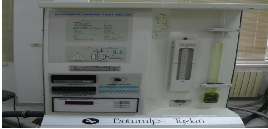
Şekil 5.4. Yakıt tüketim ölçüm ünitesinin genel görünümü
