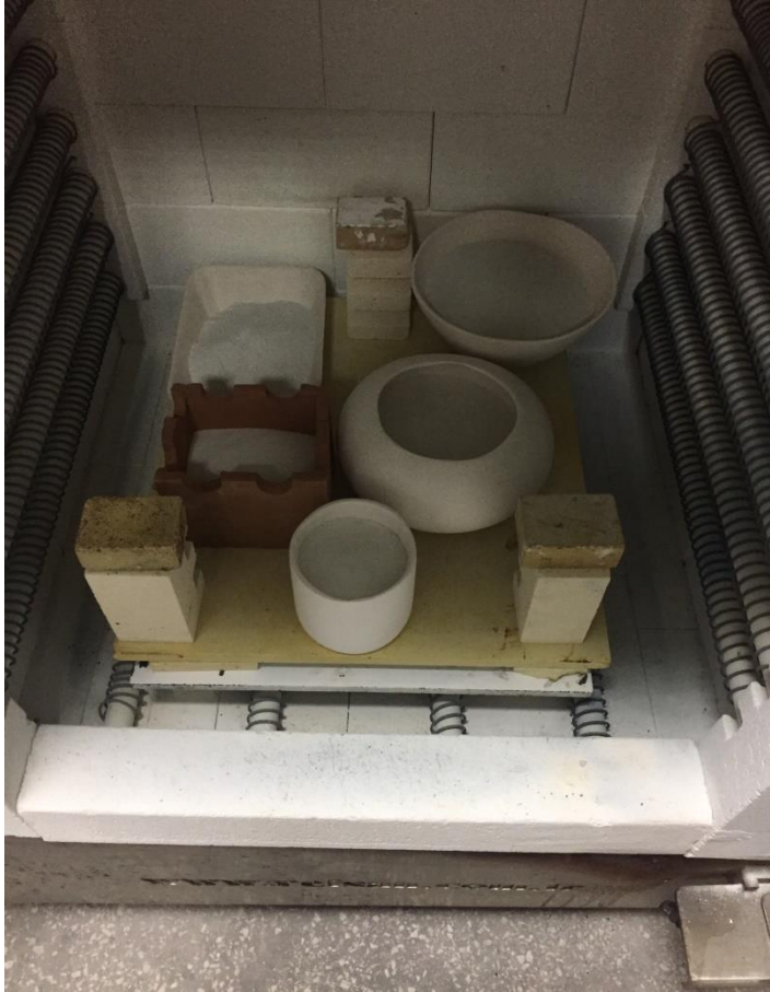
Şekil 3.1 Porselen fırındaki kalsine edilmemeden önceki dolomit
