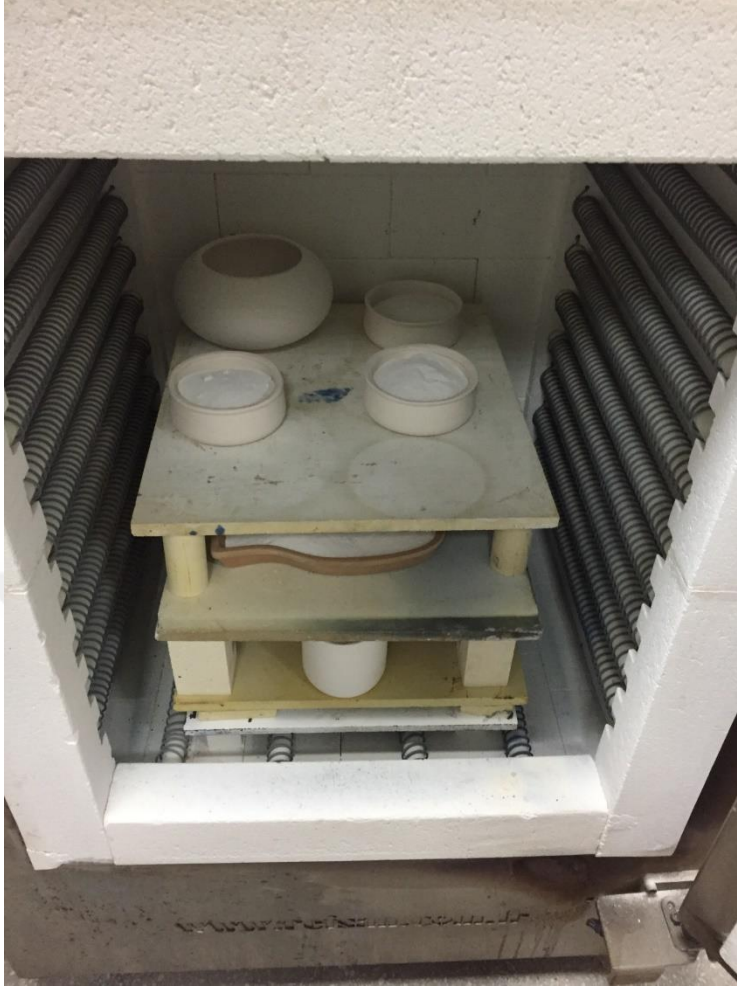
Şekil 3.2 Porselen fırındaki kalsine edildikten sonraki
