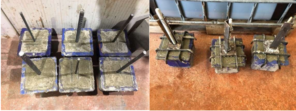
Şekil 4.19 Aderans deneyi için üretilen örnekler (Kişisel arşiv, 2020)
