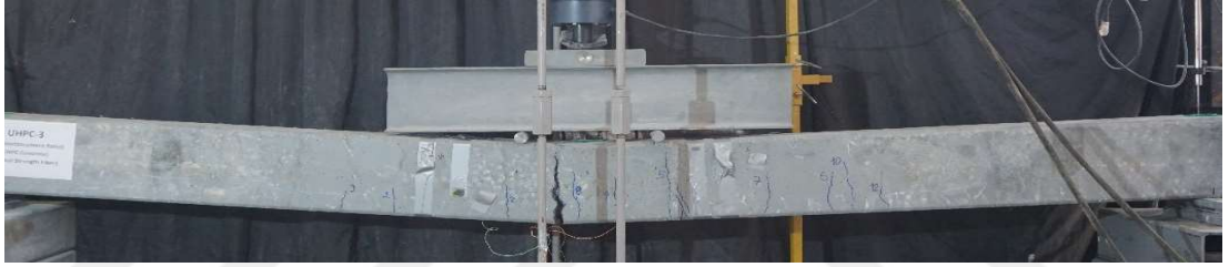
Şekil 5.6 Kiriş-1 üzerindeki 3 no'lu çatlağın 7mm'ye ulaşması (Kişisel arşiv, 2017)
