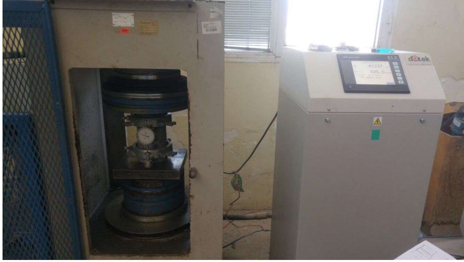
Şekil 4.8 Elastisite modülü tayini için okumaların yapıldığı test presi (Kişisel arşiv, 2017)
