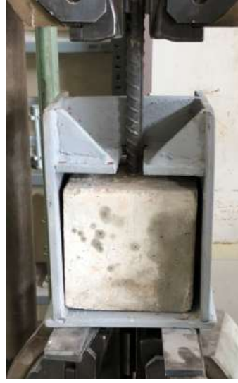
Şekil 4.20 Aderans deneyi için yapılan düzenek (Kişisel arşiv, 2020)
