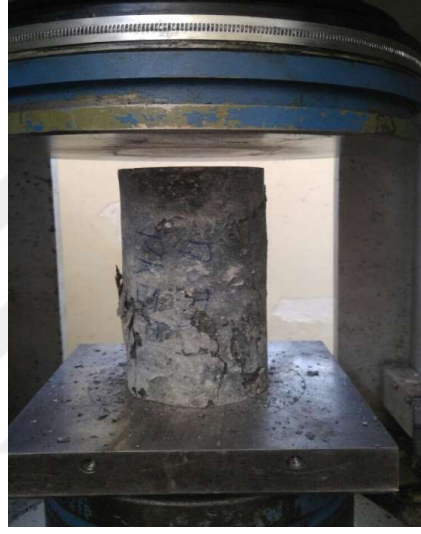
Şekil 4.7 Basınç testlerinin yapıldığı test presi (Kişisel arşiv, 2017)
