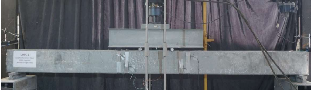
Şekil 5.3 Kiriş-1 üzerindeki rötre çatlakları (Kişisel arşiv, 2017)
