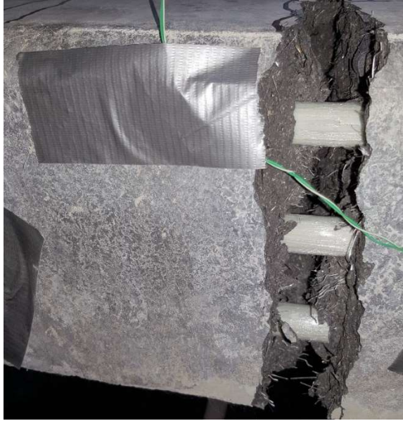
Şekil 5.22 Kiriş-4 cam lifi donatıların liflerinin ayrılması (Kişisel arşiv, 2017)
