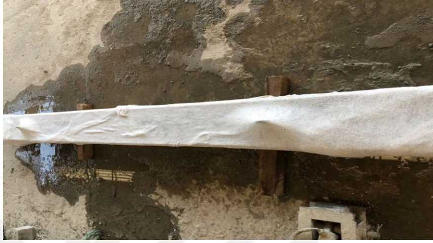
Şekil 4.5 Kiriş numunelerini kürleme işlemi (Kişisel arşiv, 2017)
