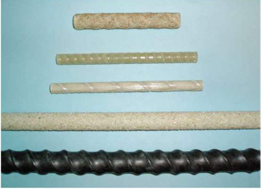
Şekil 2.2 Fiber takviyeli donatı örnekleri (ACI-440.1R-15, 2015)
