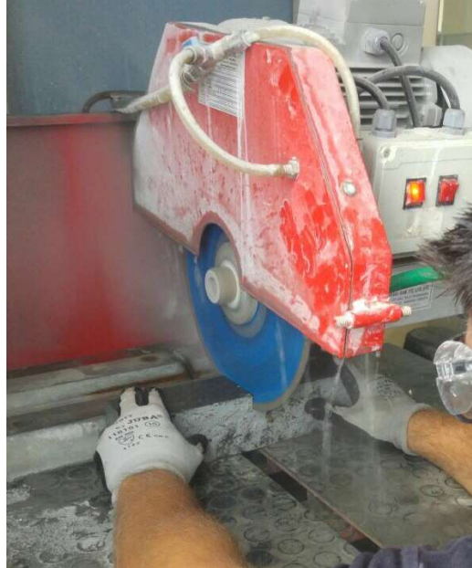
Şekil 4.9 Test Kirişlerine çentik açılması (Kişisel arşiv, 2017)
