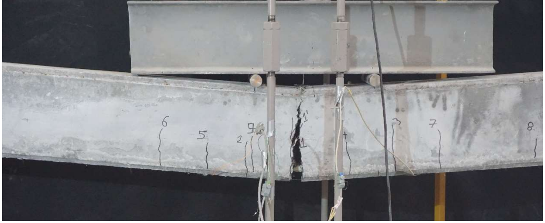
Şekil 5.20 Kiriş-4 1 nolu çatlak genişliğinin 42 mm'ye ulaşması (Kişisel arşiv, 2017)
