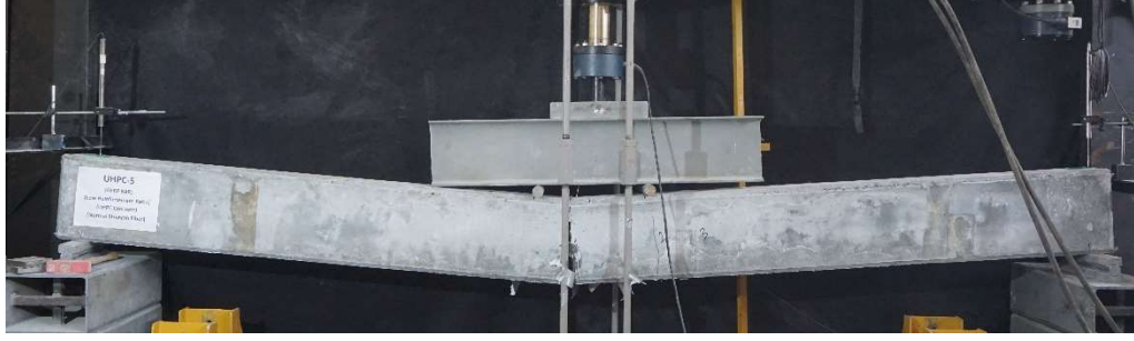
Şekil 5.15 Kiriş-3 üzerindeki 1 nolu çatlakın 52 mm boyuta ulaşması (Kişisel arşiv, 2017)
