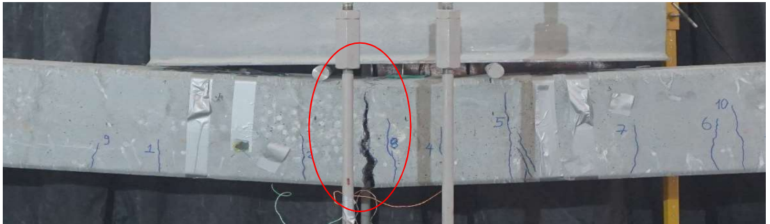
Şekil 5.7 Kiriş-1 üzerindeki 3 no'lu çatlağın 7mm'ye ulaşması (Kişisel arşiv, 2017)
