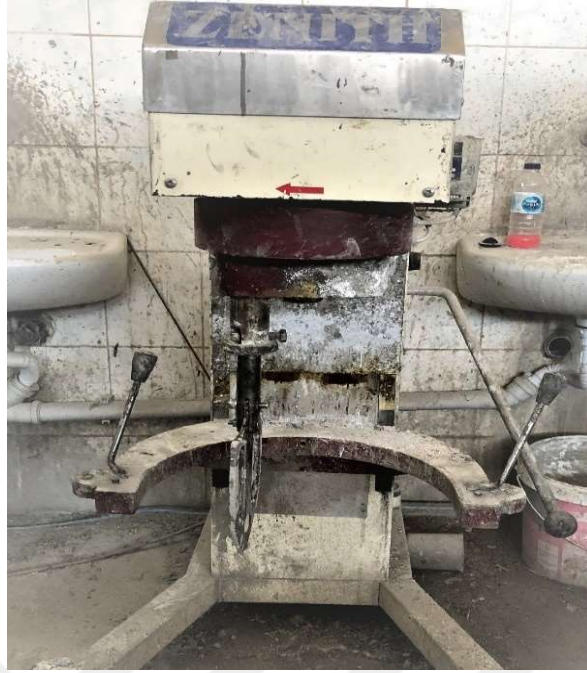
Şekil 4.4 Beton karışımlarının yapıldığı betonyer (Kişisel arşiv, 2017)
