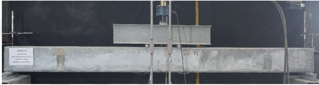
Şekil 5.17 Kiriş-4 1 nolu ilk eğilme çatlak oluşumu (Kişisel arşiv, 2017)
