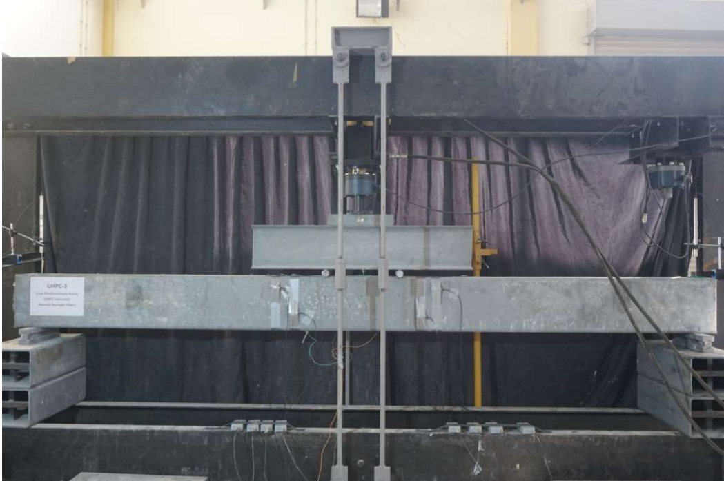
Şekil 4.10 Dört noktalı eğilme deneyi test düzeneği (Kişisel arşiv, 2018)
