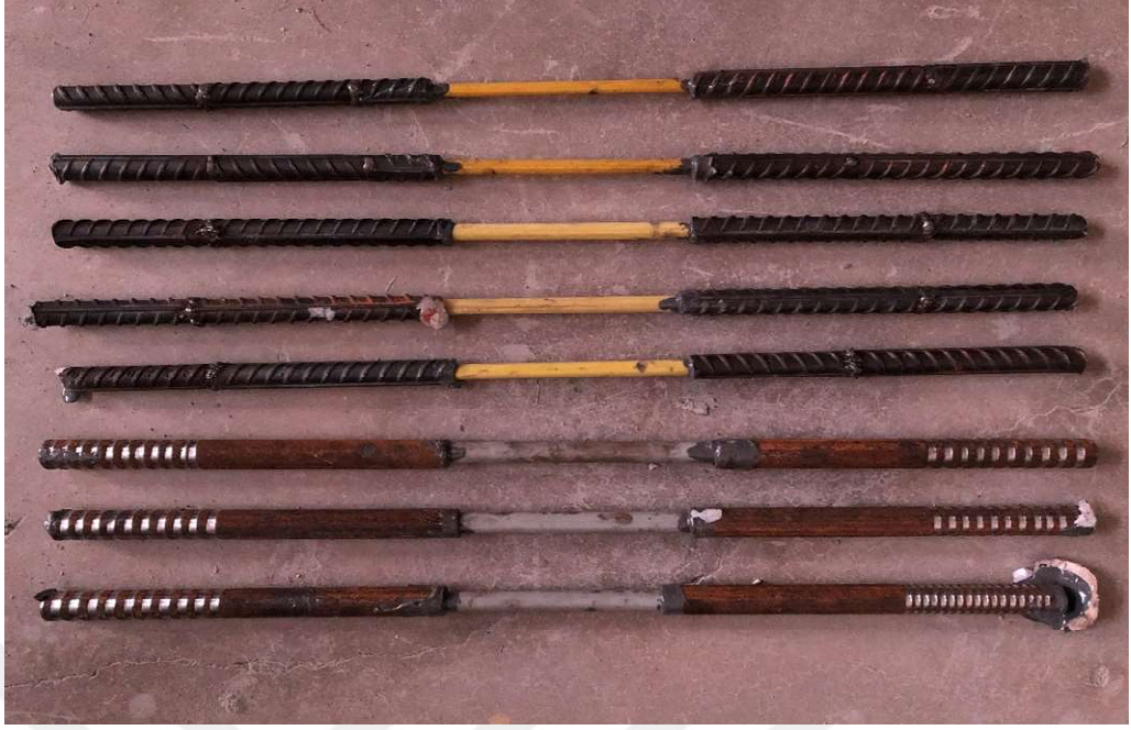
Şekil 4.14 Çekme testi için hazırlanan GFRP donatılar (Kişisel arşiv, 2019)
