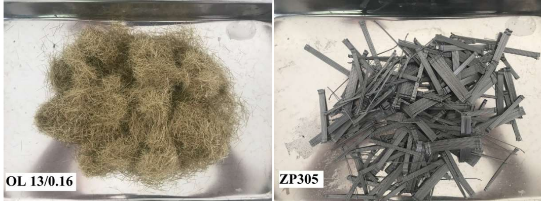
Şekil 4.2 Deneysel çalışmalarda kullanılan çelik liflerin fotoğrafları (Kişisel arşiv, 2017)
