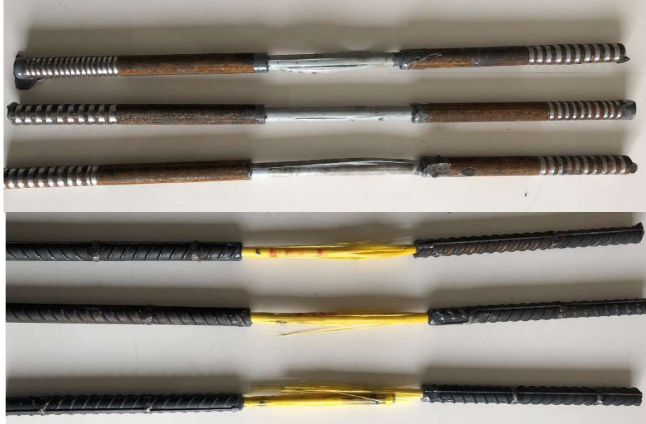
Şekil 4.16 GFRP donatıların çekme testi sonrası durumları (Kişisel arşiv, 2019)
