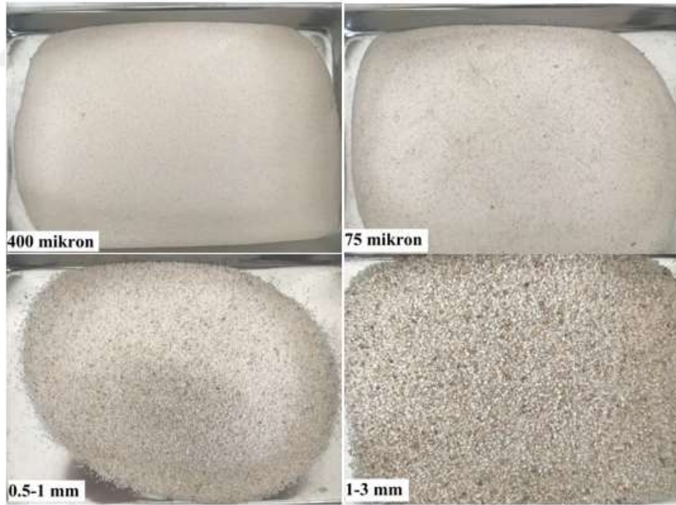
Şekil 4.1 Deneysel çalışmalarda kullanılan kuvars agregaların fotoğrafları (Kişisel arşiv, 2017)
