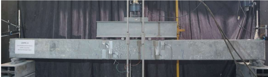
Şekil 5.4 Kiriş-1 üzerindeki 2,3 ve 5 no’lu çatlak oluşumları (Kişisel arşiv, 2017)
