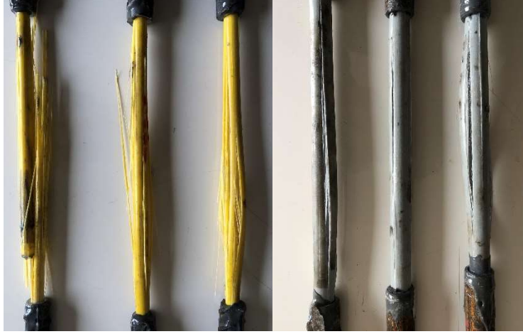
Şekil 4.17 GFRP donatıların çekme testi sonrası durumları (Kişisel arşiv, 2019)
