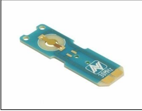
Resim 3.2. Quartz kristal mikrobalsans sensörleri
