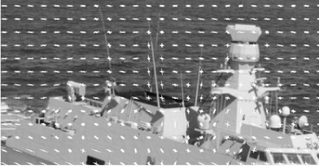
Şekil 3.2: ADA Sınıfı Korvete Ait 4x4 Blok Boyutunda ve 16x16 Hücre Boyutunda Çıkartılan Öznitelik Vektörleri.
