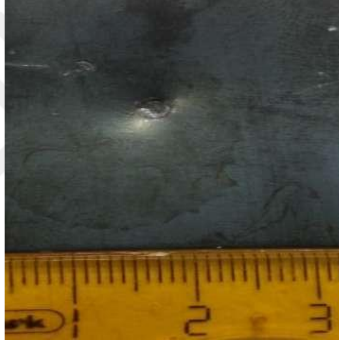
Resim 4.14 Kaplamasız M42 Çeliği Üzerindeki Serbest Düşme Deformasyon İzi.
