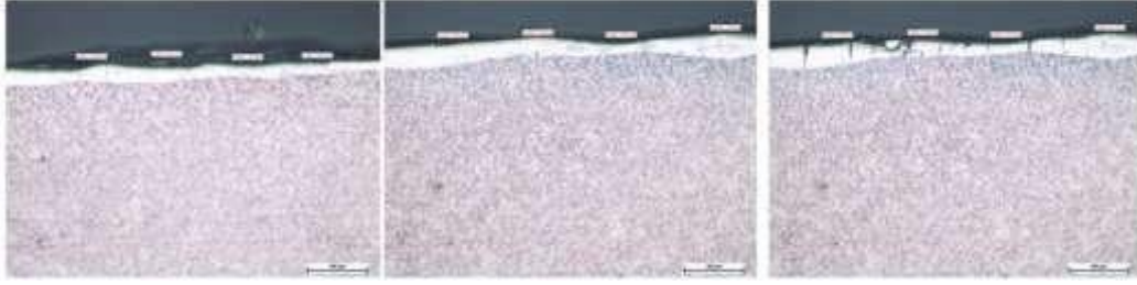
Resim 4.5 Tungsten (W) Kaplanan Numuneler, Soldan Sağa, 50V, 100V ve 150V, 1600Hz 100x Tabaka Mikroyapısı.
