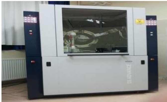
Resim 3.10 XRD Analizi için Kullanılan Bruker XRD Cihazı.
