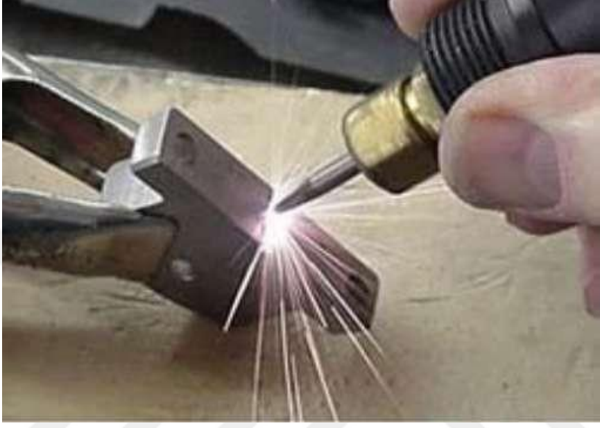
Resim 2.1 Elektro Kıvılcım Yöntemi (ESD) ile onarım yapılabilir.
