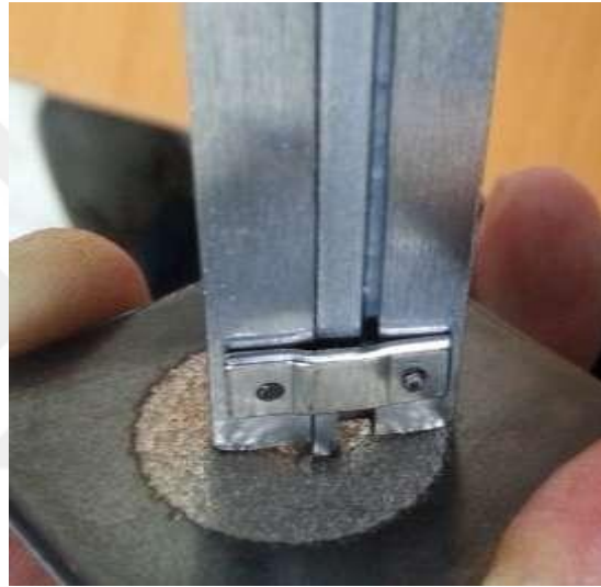
Resim 4.20 M42 Çeliği Deformasyon İndent Derinliğinin Ölçümü.
