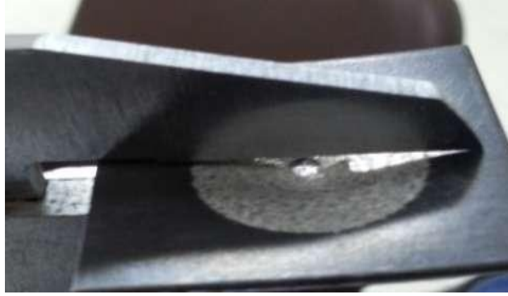
Resim 4.19 M42 Çeliği Deformasyon İz Yüksekliğinin Ölçümü.
