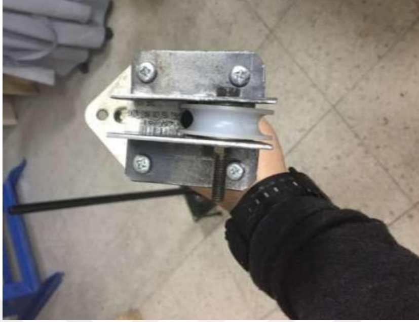
Resim 3.4 Serbest Ağırlık Düşürme Test Cihazının Makara Sistemi.
