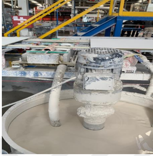
Şekil 3.9: Alt engop uygulaması.
