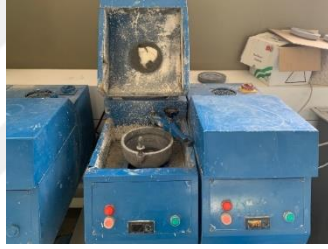
Şekil 4.2: İstenen tane boyutunu sağlayan laboratuvar tipi jet değirmen.
