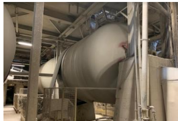
Şekil 3.2: Hammadde karışımının sağlandığı diskontinü değirmen.
