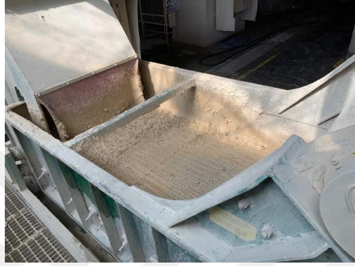
Şekil 3.3: Yabancı maddelerin giderilmesinde kullanılan titreşimli elek.
