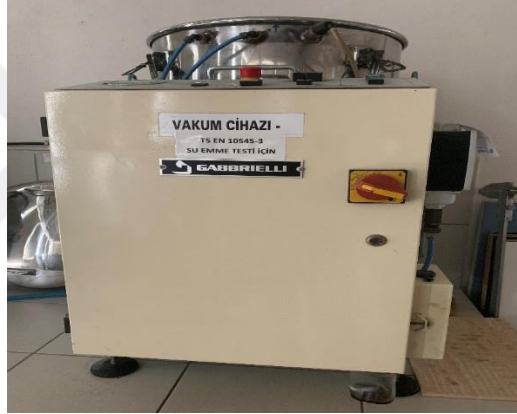
Şekil 4.9: Su emme vakum methodunda kullanılan Gabrielli marka vakum cihazı.
