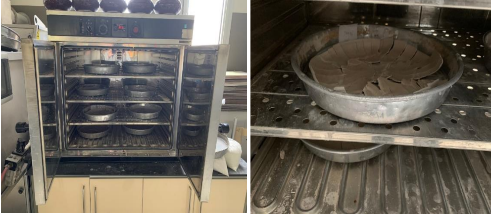
Şekil 4.5: Kullanılan laboratuvar tipi etüv ve etüvde kurutulmuş çamur.
