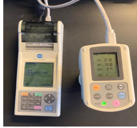
Şekil 4.10: CIA Lab renk sistemi ve renk tayininin yapıldığı minolta marka cihaz.
