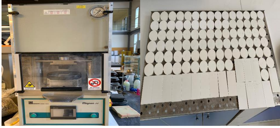
Şekil 4.7: Kullanılan laboratuvar tipi presleme cihazı ve preslenen tabletler.
