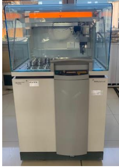
Şekil 4.17: XRF ölçümü için kullanılan Panalytical Axios marka cihaz.
