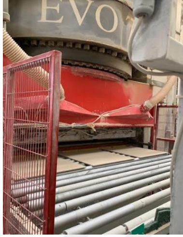
Şekil 3.5: Preslenen karonun pres çıkışı görüntüsü.
