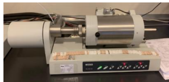
Şekil 4.15: Netzch 402 CD marka dilatometre cihazı.
