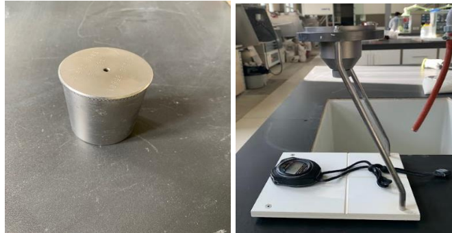
Şekil 4.4: Yoğunluk ölçümünde kullanılan piknometre ve ford cup.
