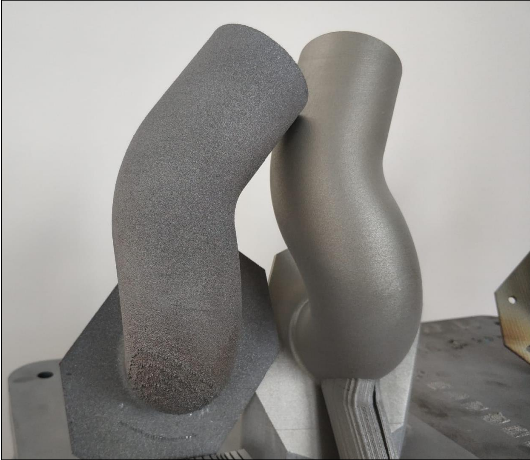
Şekil 2.5. EBM ve SLM yöntemleri ile üretilmiş iki parça
