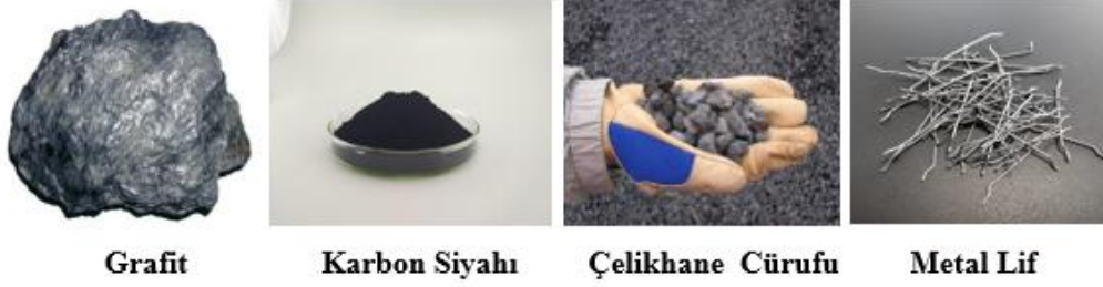
Resim 2.11 İletken asfalt betonunda kullanılan öz direnci düşük iletken malzemeler (İnt. Kyn.3, İnt. Kyn.4, İnt. Kyn.5, İnt. Kyn.6).
