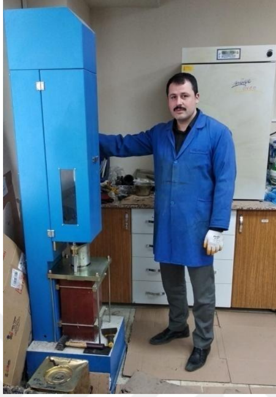
Resim 3.5 TMA numunelerinin Marshall Tokmağında sıkıştırılması.
