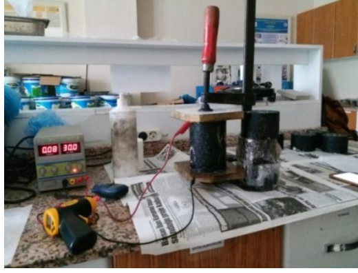
Resim 3.8. İki Elektrot yöntemi ile 2'li birleştirilmiş numunelerin özdirenç ölçümü.
