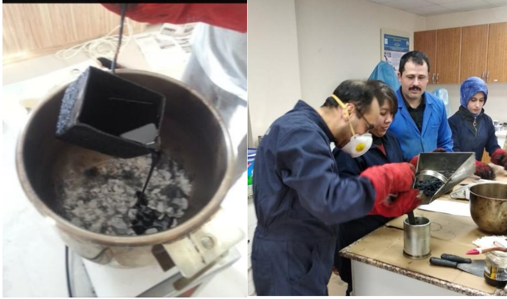
Resim 3.3 Karışımlara bitüm eklenmesi ve TMA karışımının kalıplara konulması.
