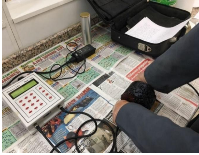
Resim 3.11 İletken TMA numunesinin ultrases ölçümü.
