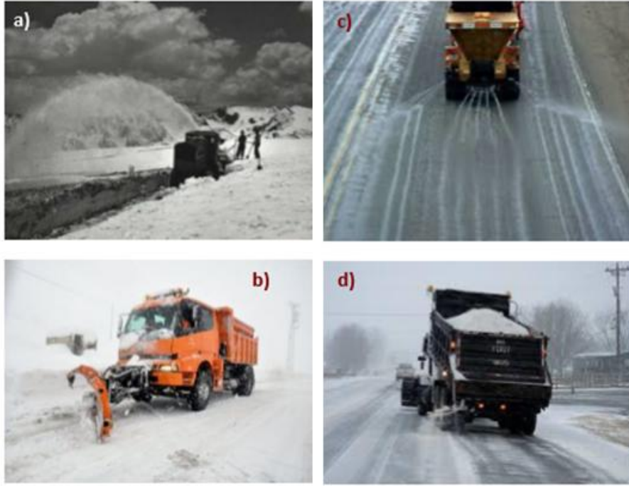
Resim 2.8 Kar ve buzlanma ile pasif mücadele yöntemleri: a) kar bloweri b) kar sıyırıcı c) solvent serici d) tuzlama çalışması (Gürer 2014).
