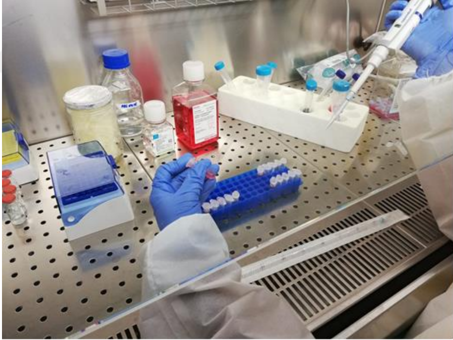
Şekil 3.9. Deney kapsamında kullanılacak nanopartikül dispersiyonlarının seyreltme işlemlerinin gerçekleştirilmesi.
