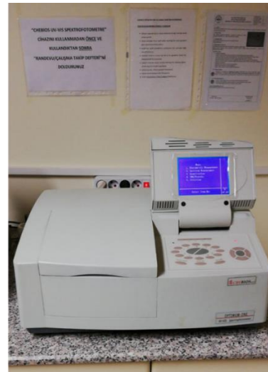
Şekil 3.5. Müsinle etkileşim çalışmaları kapsamında gerçekleştirilen türbidimetrik tayin analizlerinin spektrofotometre cihazı ile gerçekleştirilmesi süreci.
