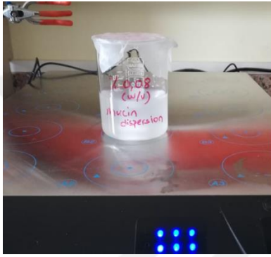
Şekil 3.4. Müsinle etkileşim çalışmaları kapsamında gerçekleştirilen türbidimetrik tayin analizlerinin gerçekleştirilmesi amacıyla müsin dispersiyonu hazırlanması işlemi.
