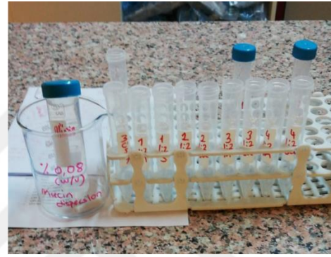
Şekil 3.4. Müsinle etkileşim çalışmaları kapsamında gerçekleştirilen türbidimetrik tayin analizlerinin gerçekleştirilmesi amacıyla müsin dispersiyonu hazırlanması işlemi.
