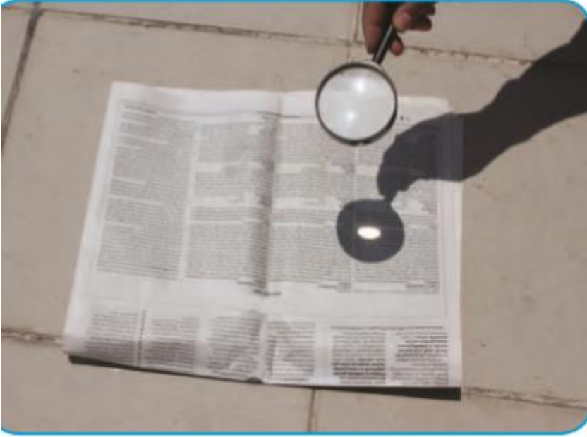
Görsel 203: MEB. (2019). 7. sınıf. s:181'de ince kenarlı merceğin ışığı kırıp bir noktada toplama özelliği ile ilişkili görsele yer verilmiştir.
