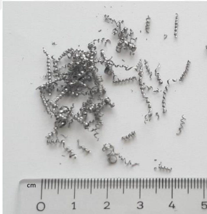
Şekil 3.23 a=0,25 , s=0,2 , \nu=65^\circ Sonucu Talaş Durumu
