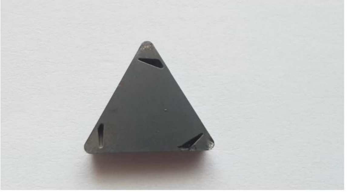
Şekil 3.18 TPUN160308 Takıma 4, 5, 6' nolu Parametre Deney Sonuçları Dalma erozyon tezgahında bakır elektrot yardımıyla oluşturulan formların Şekil 3.17 ve 3.18'deki görüntüleri.
