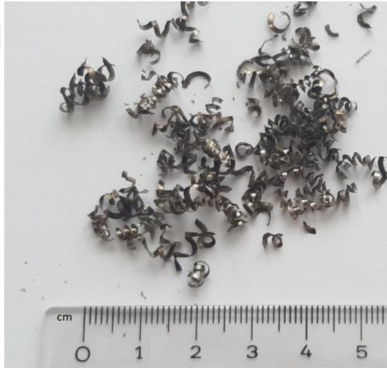
Şekil 3.21 a=0,5 , s=0,4 , \nu=60^\circ Sonucu Talaş Durumu
