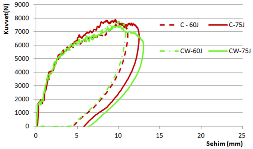
Şekil 3.12 C ve CW kompozitlerin 60J ve 75J enerjilerinde darbe davranışları
