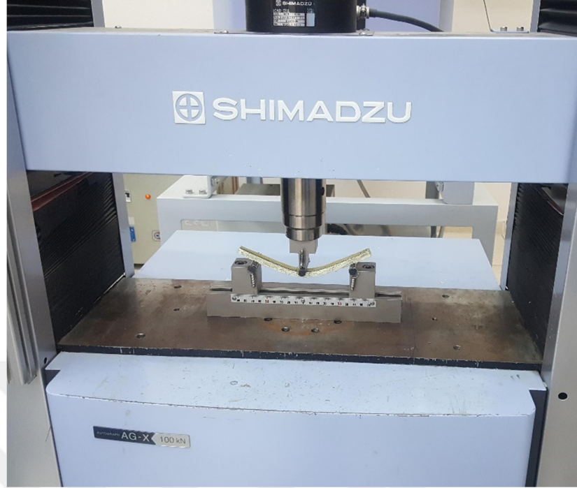
Şekil 2.13 3 nokta eğilme testi esnasında numune (Kişisel arşiv, 2019)
