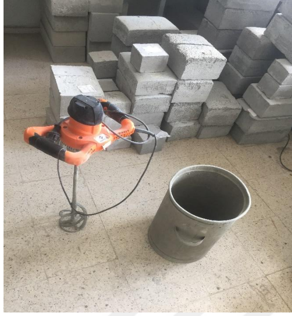
Resim 3.6 Karıştırma el mikseri (solda), karıştırma kabı (sağda).
