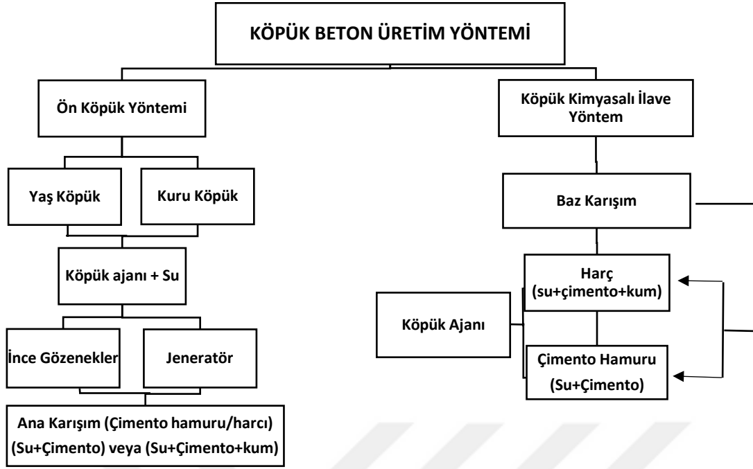
Şekil 2.1 Gözenekli beton ve köpük beton üretim yöntemleri.
