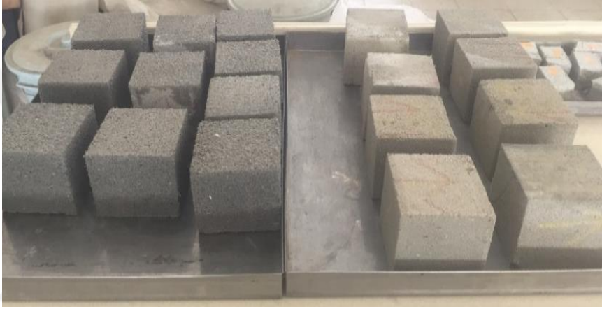
Resim 3.5 10x10x10 cm ebatlandırılmış köpük beton numuneleri.
