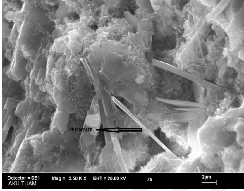
Resim 4.5 Köpük beton için kullanılan PP fiberlerin yapı içindeki görüntüsü.
