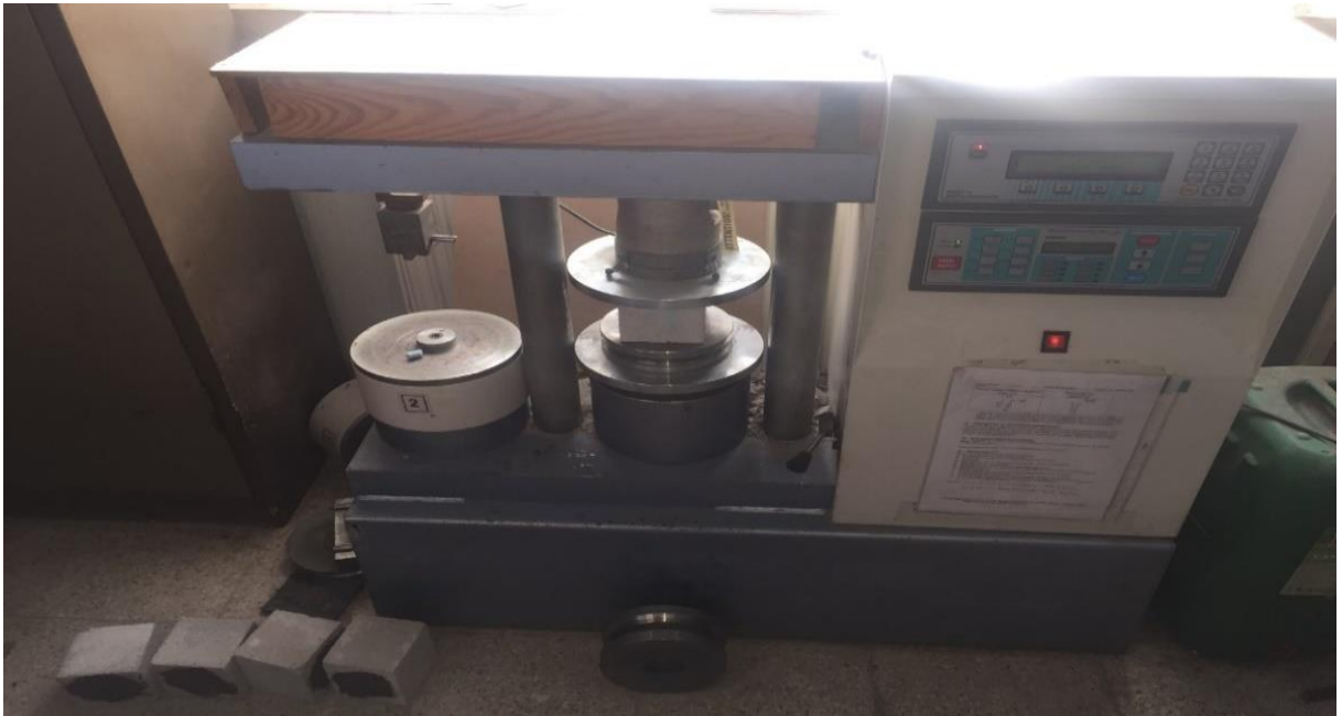
Resim 3.9 Numunelere uygulanan basınç mukavemeti deneyi.
