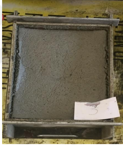
Resim 3.7 Genleşme sonrası çökme gerçekleşmiş numune.
