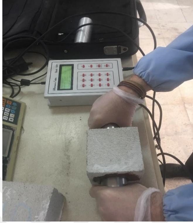
Resim 3.12 Numunelere uygulanan ultrases deneyi.
