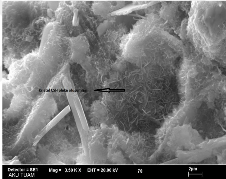
Resim 4.3 Numune içerisinde gözlemlenen kristal CSH plaka oluşumları.
