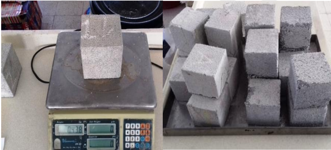
Resim 3.10 Etüv kuru numunelerin tartımı.
