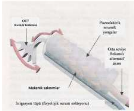
Şekil 2.2. Piezoelektrik cerrahi cihazının çalışmasının şematik çizimi [61]
