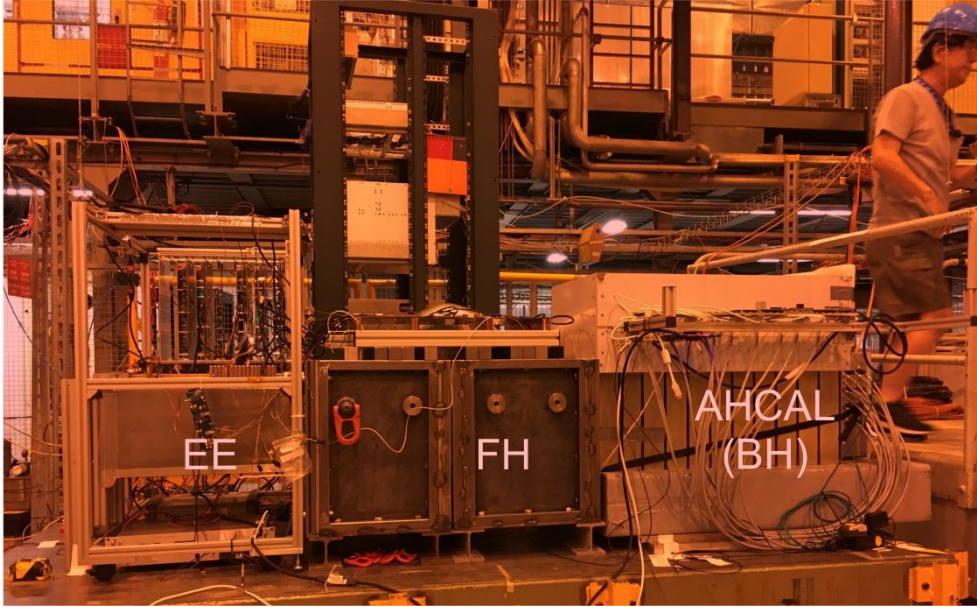
Şekil 3.14. HGCAL test düzeneğinin CERN'deki gerçek görüntüsü. EE, FH ve BH kısımlarının görüntüsü.
