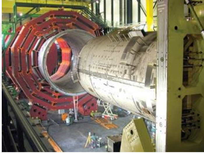
Şekil 2.12. Süperiletken mıknatıs ve müon odalarının yerleşik düzeni. (CERN Courier, 2012.)
