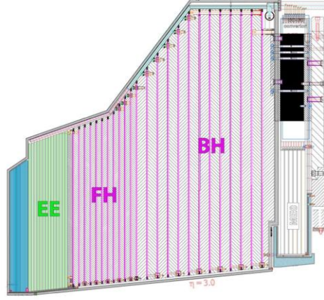
Şekil 3.2. HGCal genel yapısının ve EE, FH, ve BH kısımlarının teknik çizimi. (CMS Collaboration, CERN-LHCC-2015-010, 2015.)
