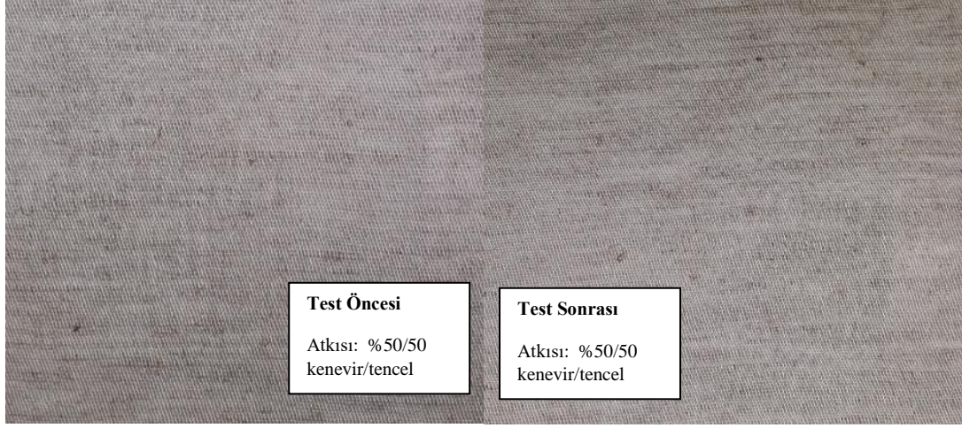
Şekil 4.6. %50/50 Kenevir/tencel atkı iplikli kumaşların boncuklanma testi öncesi ve sonrasına ait kumaş görünümleri
