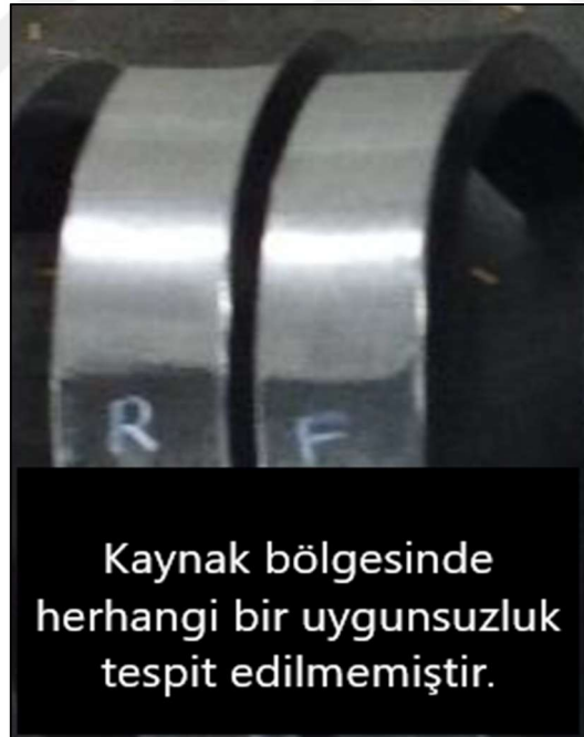
Şekil 4.32: Kaynak bölgesine yapılan katlama testi sonrası numune görüntüsü.
