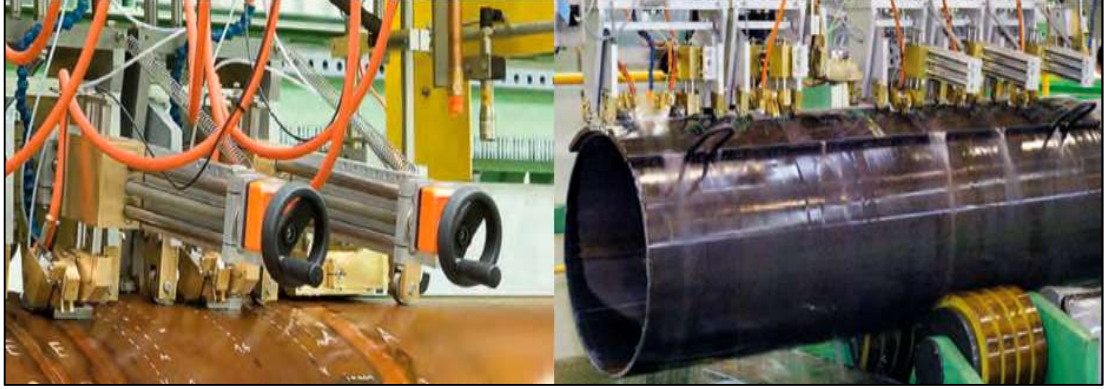
Şekil 2.14: Üretim anında ve sonrasında yapılan ultrasonik kontroller [42].
