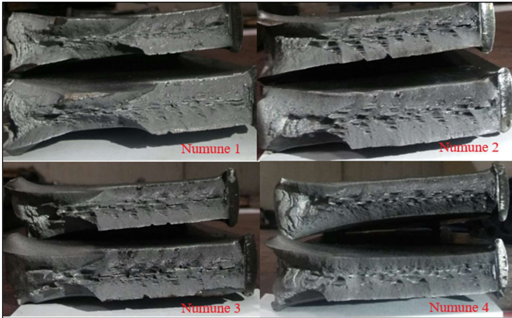
Şekil 4.40: Borudan alınan 4 numuneye ait ağırlık düşürmeli yırtma testi sonrası kırık yüzey görüntüleri.
