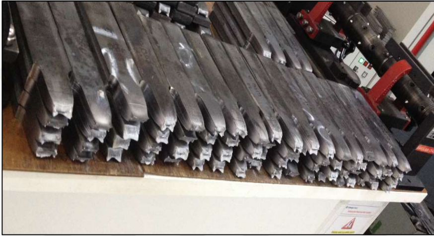
Şekil 4.13: Çekme testi sonrası numune görüntüleri.
