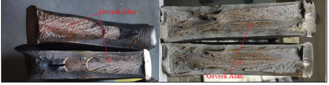
Şekil 4.41: Ağırılık düşürmeli yırtma testinde gevrek kırılmaya ait temsili numune görüntüsü.
