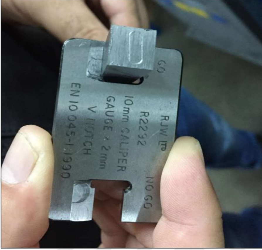
Şekil 4.17: Darbe numunelerine açılan çentiklerin standart masterla uygunluk kontrolü.
