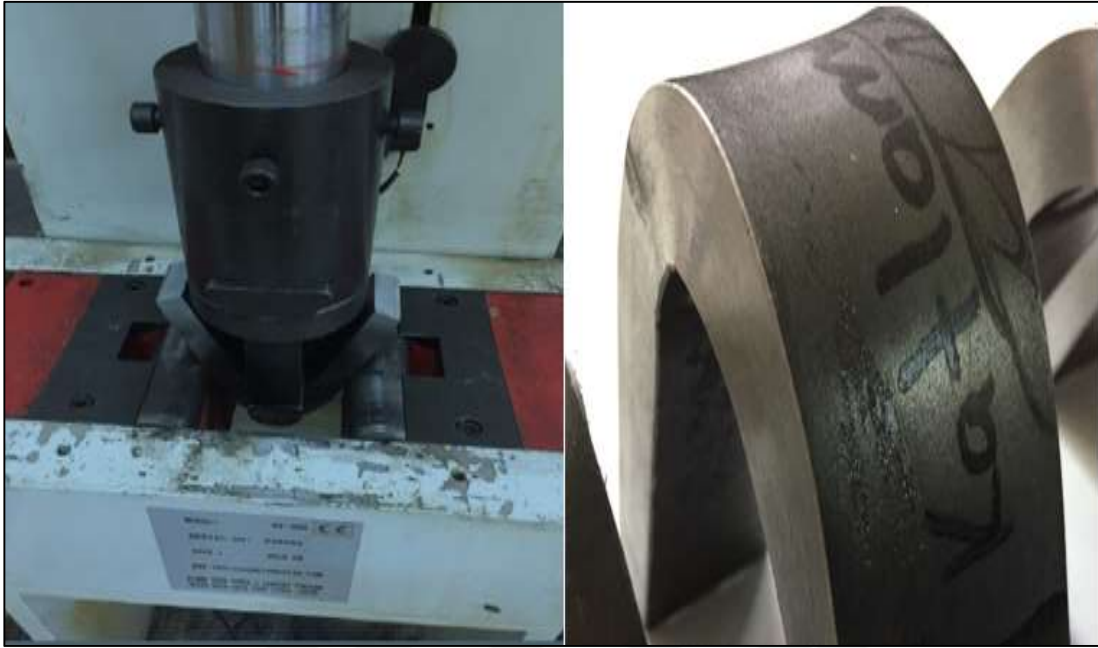
Şekil 4.26: Katlama testi ve test sonrası numune görüntüsü.
