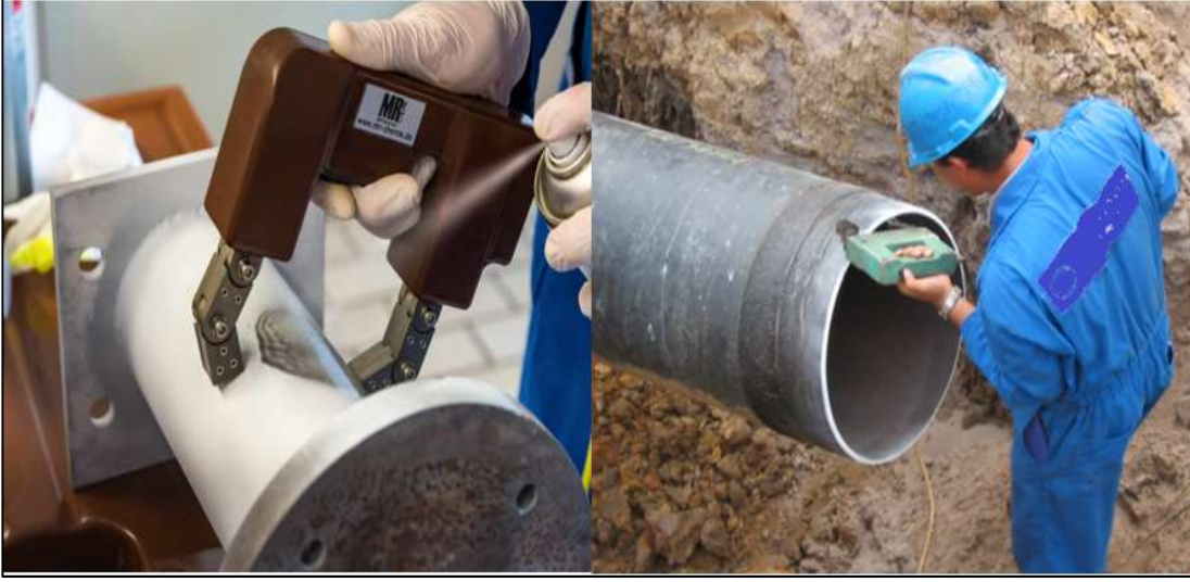
Şekil 2.16: Manyetik partikül yöntemi ile kontrol [45].
