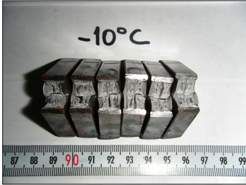
Şekil 4.10: Test sonrası darbe numuneleri.
