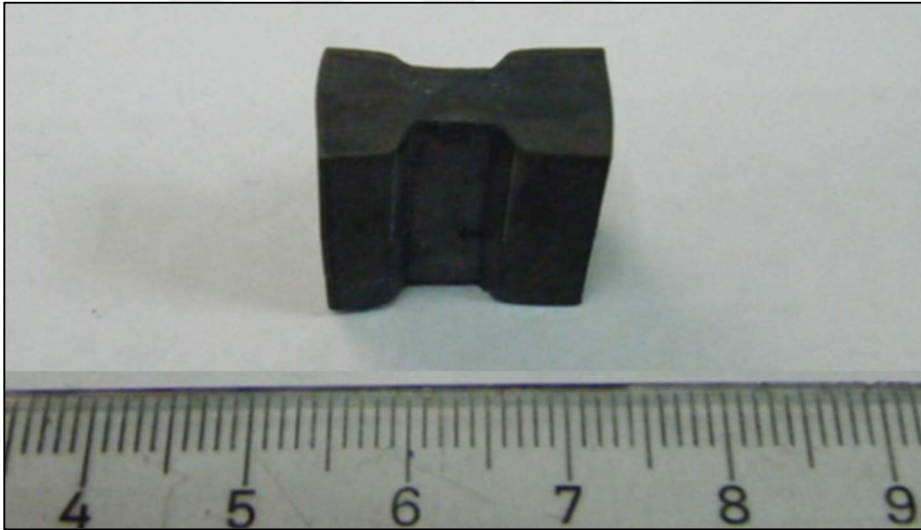
Şekil 4.3: Düzlem deformasyon testi sonrası numune görüntüsü.
