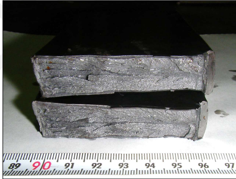
Şekil 4.11: Ağırlık düşürmeli yırtma testi sonrası numune kırık yüzeyi.
