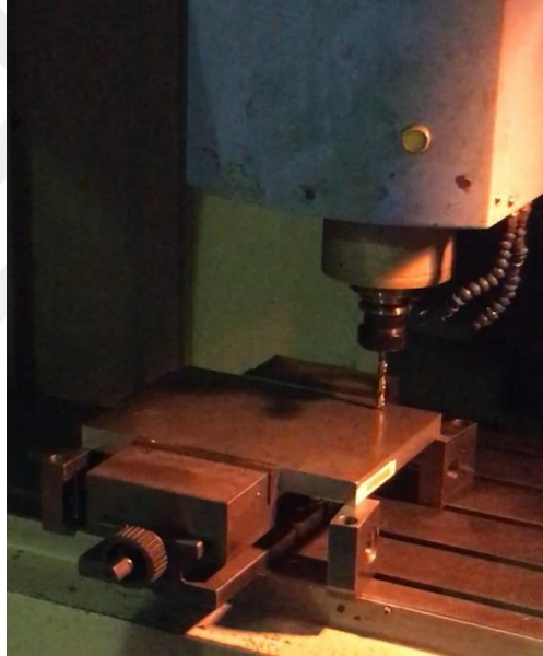
Şekil 3. 4 - Deney Çalışmasında 7075 Alüminyum Alaşımın Tezgaha Bağlanmış Hali
