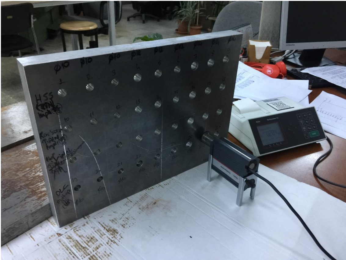
Şekil 3. 62 - Alüminyum 7075 – T651 Alaşımında Oluşan Deliklerin Yüzey Pürüz Ölçer Aleti Kullanarak Ölçülmesi
