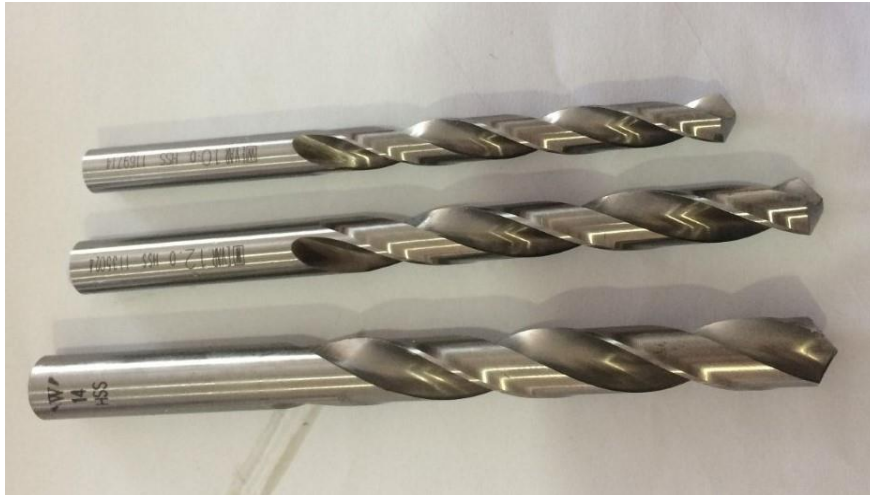
Şekil 2. 9 - Taşlanmış ø10 – ø 12 – ø14 mm Çaplarındaki HSS Matkap Uçlar
