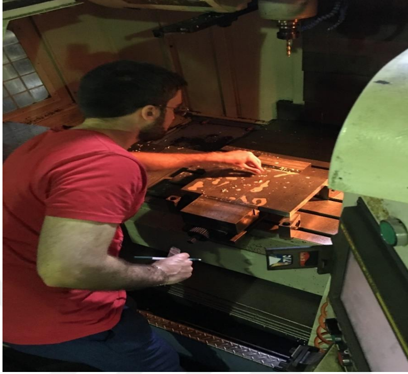
Şekil 3. 73 - Delme Sonucu Alüminyum Alaşımından Kopan Talaşların Toplanması
