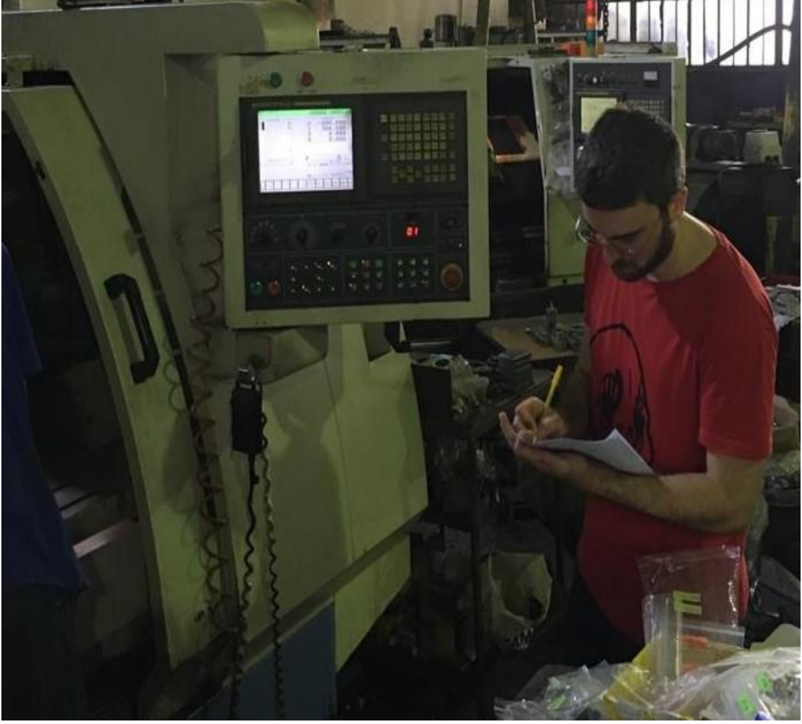
Şekil 3. 75 – CNC Dik İşleme Tezgahın Kontrol Ünitesinde Kaydedilen İşlem Süresinin Takibi
