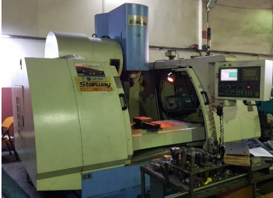
Şekil 3. 1 - Starway VMC – 1060 model CNC Dik İşleme Tezgahı
