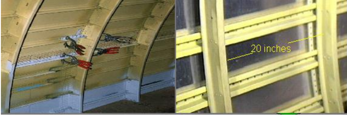
Şekil 2. 1 - 7075 Alüminyum Alaşımının Kullanıldığı Uçağın Yapı Elemanlarından Olan Kiriş ve Yapı İskeleti
