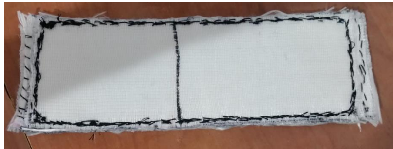
Şekil 3.4. ST40 numunesinin dikiş sonrası görünümü
