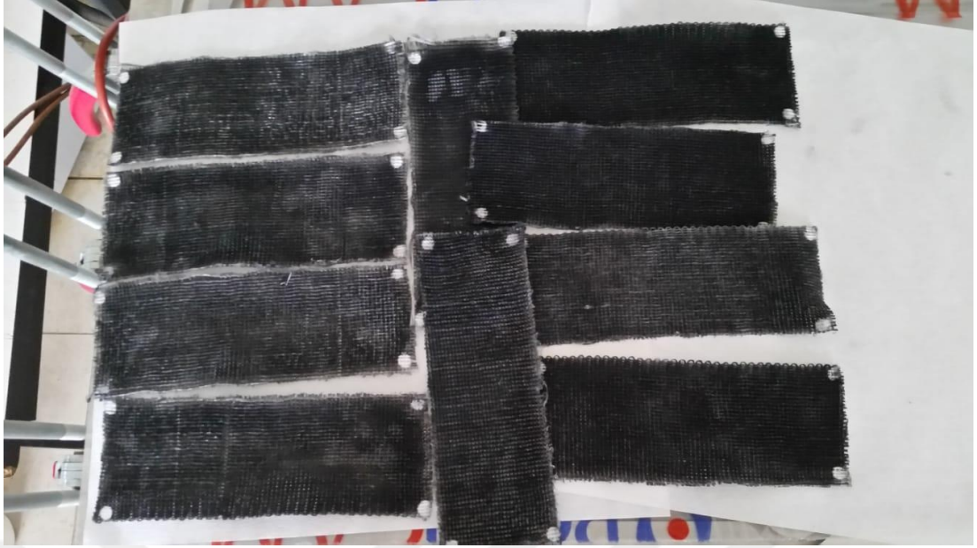
Şekil 3.3. CNT püskürtülmüş 10 kat kumaşın görüntüsü
