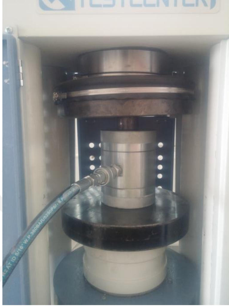
Şekil 6.11 Üç eksenli basınç dayanımı deneyi.
