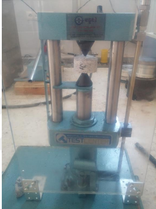
Şekil 6.7 Nokta yükleme deneyi yapılışı.
