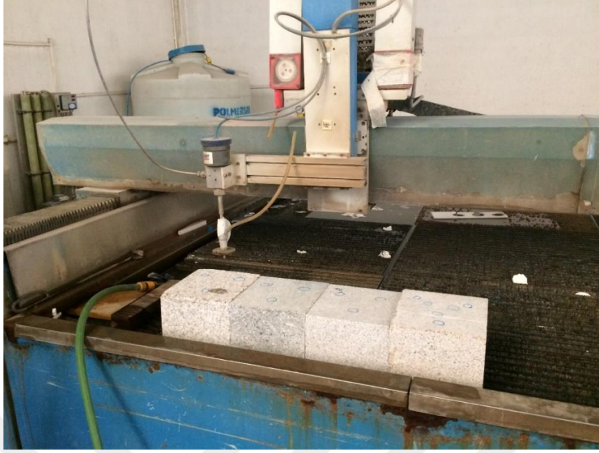
Şekil 6.27 Su jeti makinesinde gerçekleştirilen hidrolik çatlatma uygulamalarından bir görünüm.
