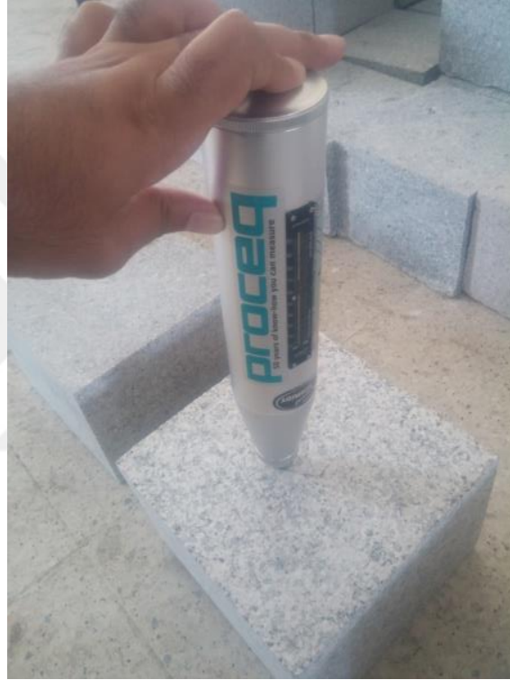
Şekil 6.6 Schmidt çekici ile yapılan ölçümler.
