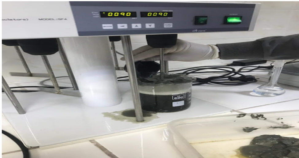
Şekil 3.1.1. Kimyasal Koagülasyon Deney Düzeneği (Jar Testi)
