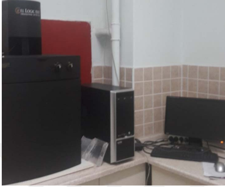
Şekil 3.8. Jel görüntüleme sistemi (Gel Logic 1500 Imaging Sistem)
