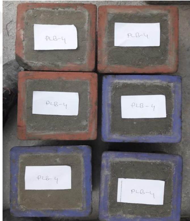
Şekil Ek 1.12. Genleştirilmiş Perlit Lifli Basınç Numuneleri
