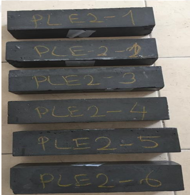
Şekil Ek 1.10. Ham Perlit Lifli Eğilme Numuneleri
