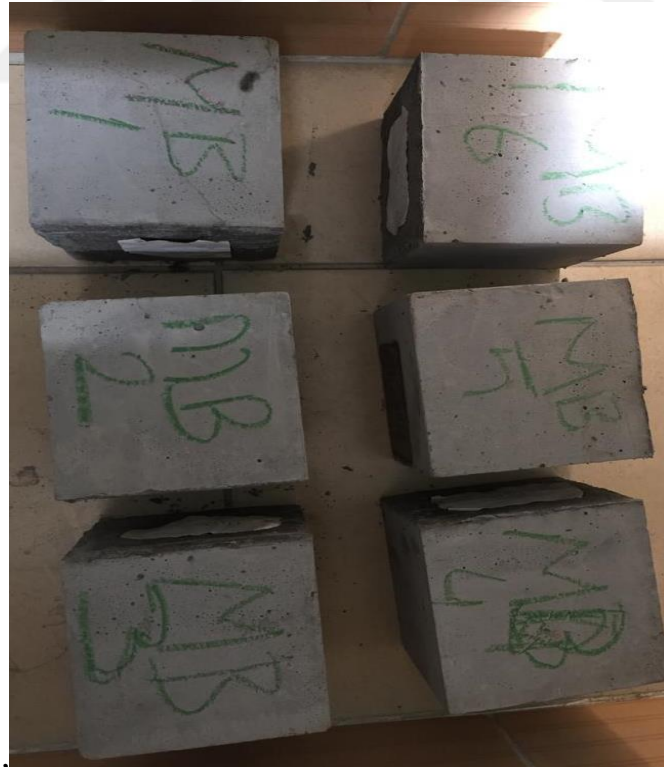
Şekil Ek 1.4. Mermer Lifsiz Basınç Numuneleri
