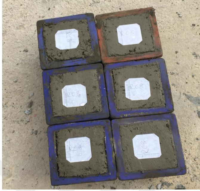
Şekil Ek 1.1. Kontrol Betonü Basınç Numuneleri
