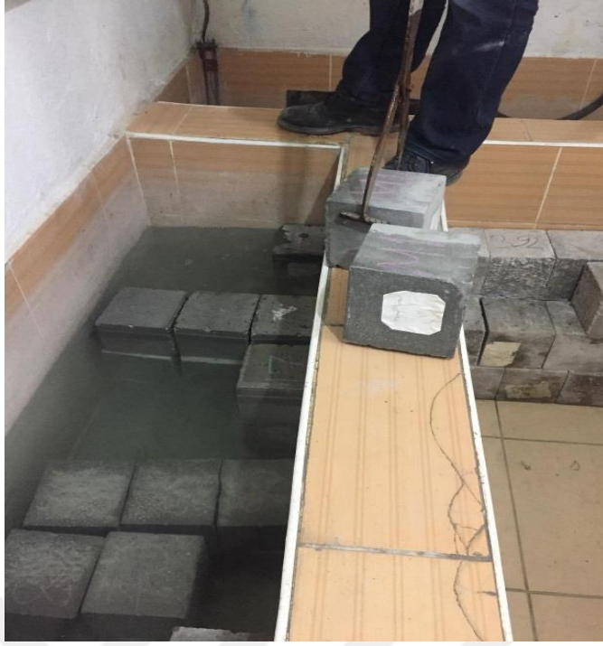
Őekil Ek 1.19. Beton Kr Havuzu
