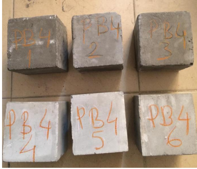
Şekil Ek 1.11. Genleştirilmiş Perlit Lifsiz Basınç Numuneleri
