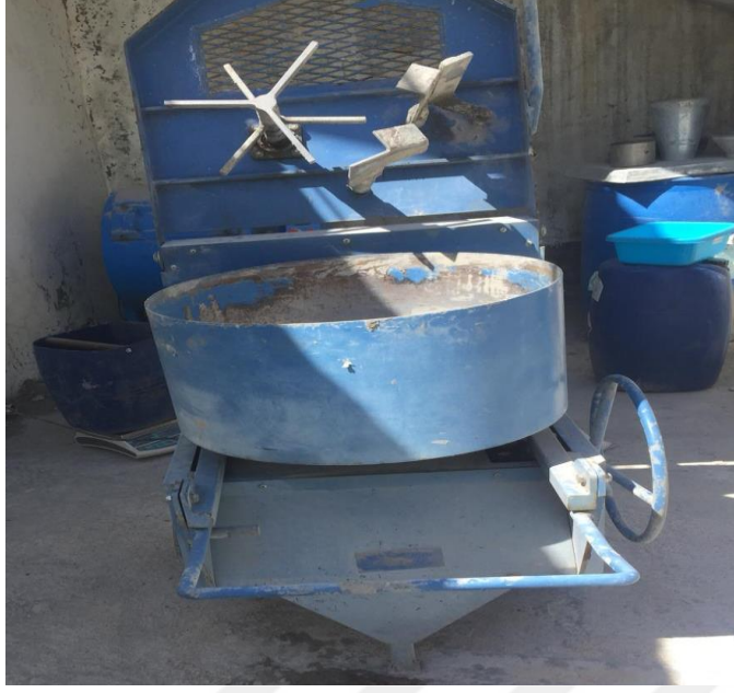
Şekil Ek 1.17. Beton Mikseri
