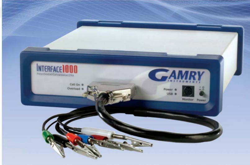
Şekil 3.3. Gamry Interface 1000 Potansiyostat ölçüm cihazı
