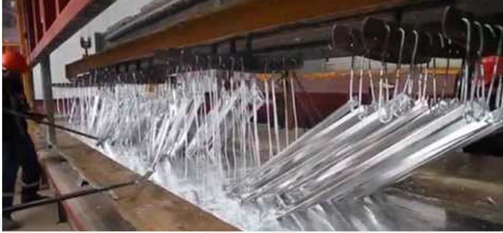
Şekil 1.2. Sıcak daldırma yöntemi ile galvaniz kaplanmış malzeme örneği
