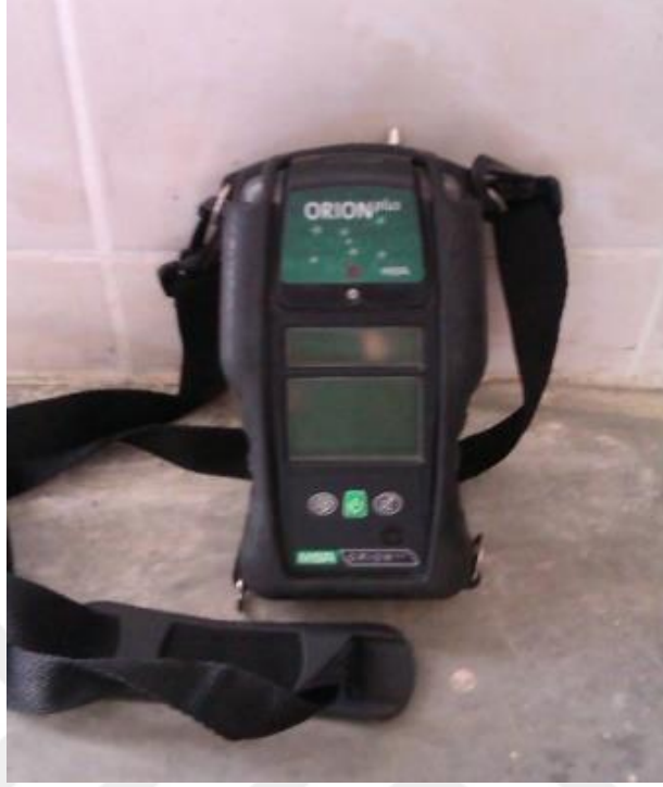
Şekil 12 : Çoklu gaz ölçüm cihazı (O 2 ,CO,CO 2 ,LEL,PID sensörlü) [15].
