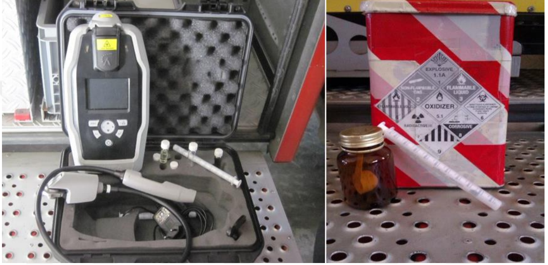
Şekil 11 : First defender analiz cihazı (raman spektrofotometresi) [15].
