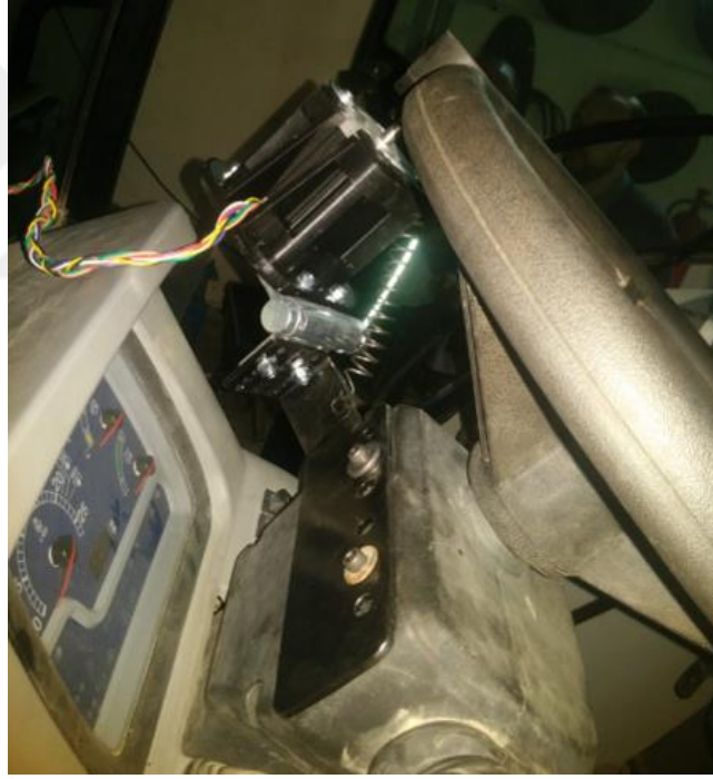
Şekil 3.9. Servo motorun montajı
