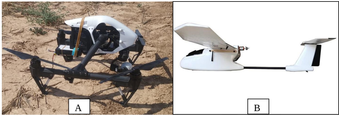
Şekil 3.16. A: Döner kanatlı görüntüleme sistemi, B: Sabit kanatlı görüntüleme sistemi
