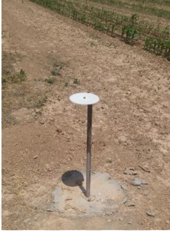
Şekil 3.14. Arazi köşe noktalarına beton ile sabitlenen YKN görüntüsü
