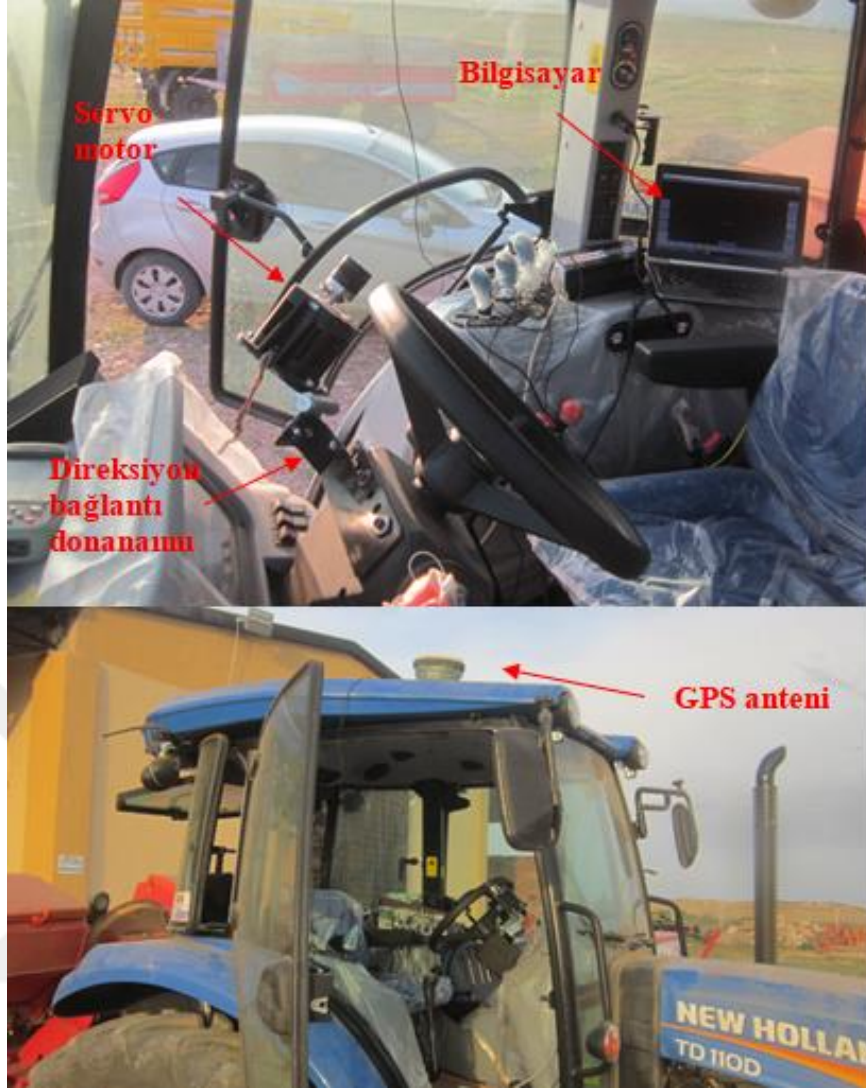
Şekil 3.10. GPS ve otomatik kontrol sisteminin genel görünüşü
