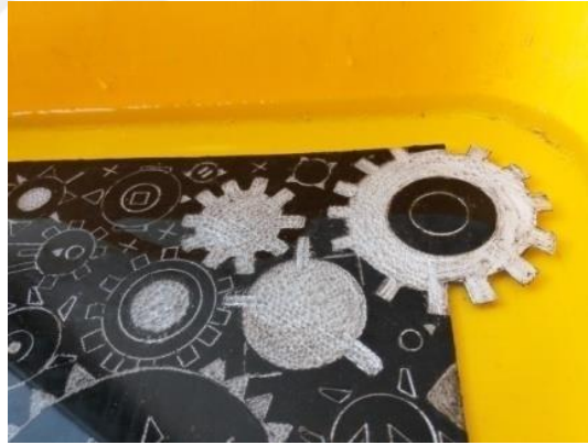
Görsel 58. Çinko kalıba, plastik kaptaki asit indirgemesi
