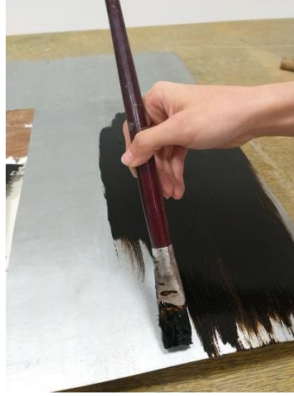
Görsel 57. Çinko kalıbın (lak) ziftlenmesi
