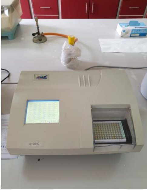
Şekil 12. ELISA okuyucusu (Optic IvyMen system, 20100-C, İspanya).
