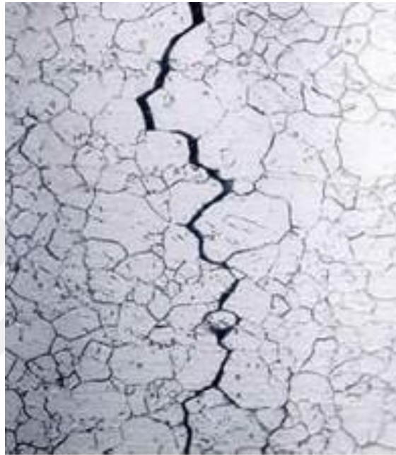
Şekil 2.8. Gerilmeli korozyon ve çatlak oluşumu (URL-4, 2019).
