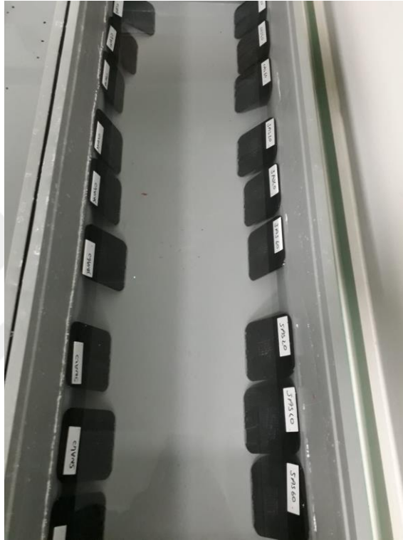
Şekil 4.10. Tuzlu su ortamına dayanım testine maruz bırakılan plakalara ait fotoğraf.
