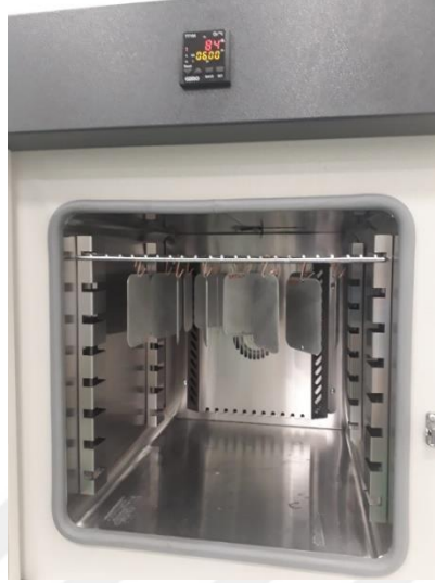
Şekil 4.3. Pasive edilmiş plakaların etüvde kurutulmasına ait fotoğraf.
