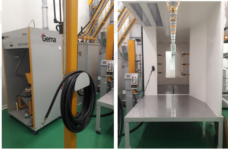
Şekil 2.1. Otomatik elektrostatik toz boya sistemine ait fotoğraf.
