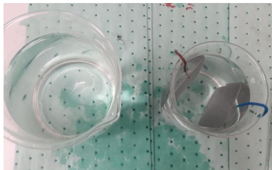
Şekil 4.2. Daldırma metodu ile plakaların pasive edilmesine ait fotoğraf.
