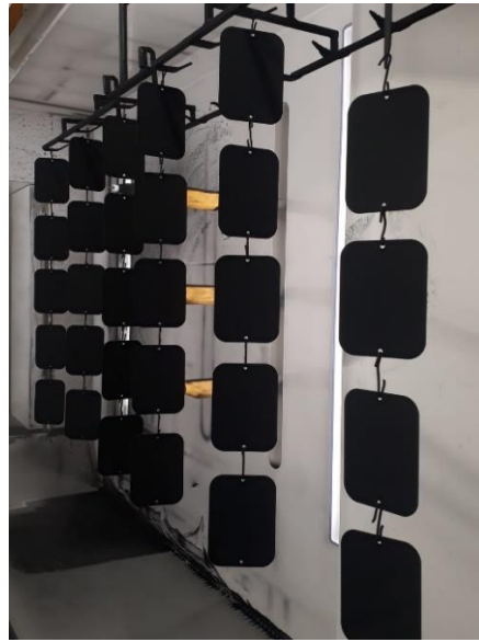
Şekil 4.6. Elektrostatik toz boya ile kaplanması sonrasına ait fotoğraf.
